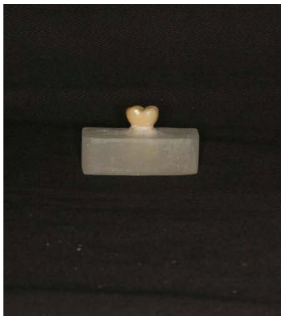
FIGURA 3 - Bloco de resina acrílica com dente artificial inserido
