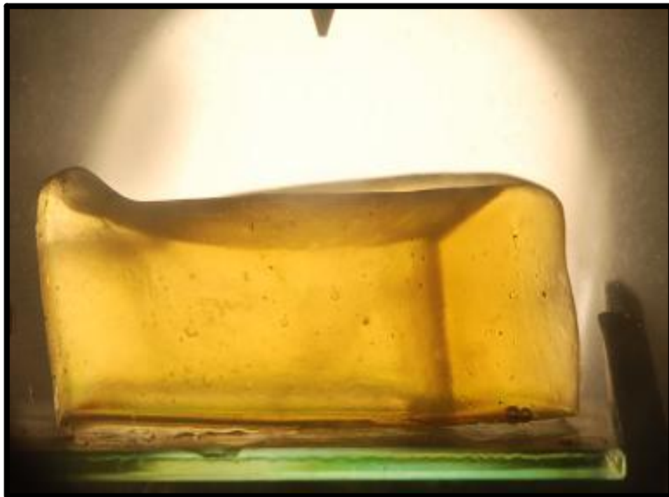
Figura 20 - Modelo fotoelástico livre de tensões iniciais.
