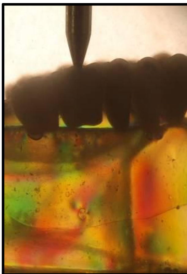
Figura 1 - Aplicação de carga no modelo fotoelástico mucossuportado, sem implante (Grupo I); lado oposto da comunicação buco-sinonasal.
