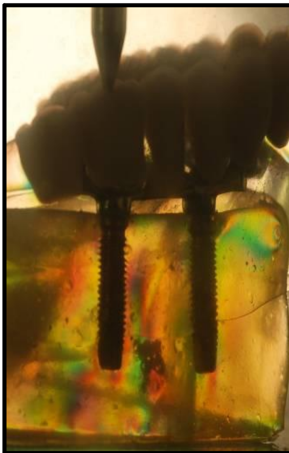
Figura 2 - Aplicação de carga no modelo fotoelástico com sistema de retenção o'ring /barra (Grupo II).
