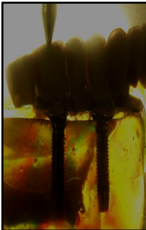
Figura 2 - Aplicação de carga no modelo fotoelástico com sistema de retenção o'ring /barra clipe (Grupo II).
