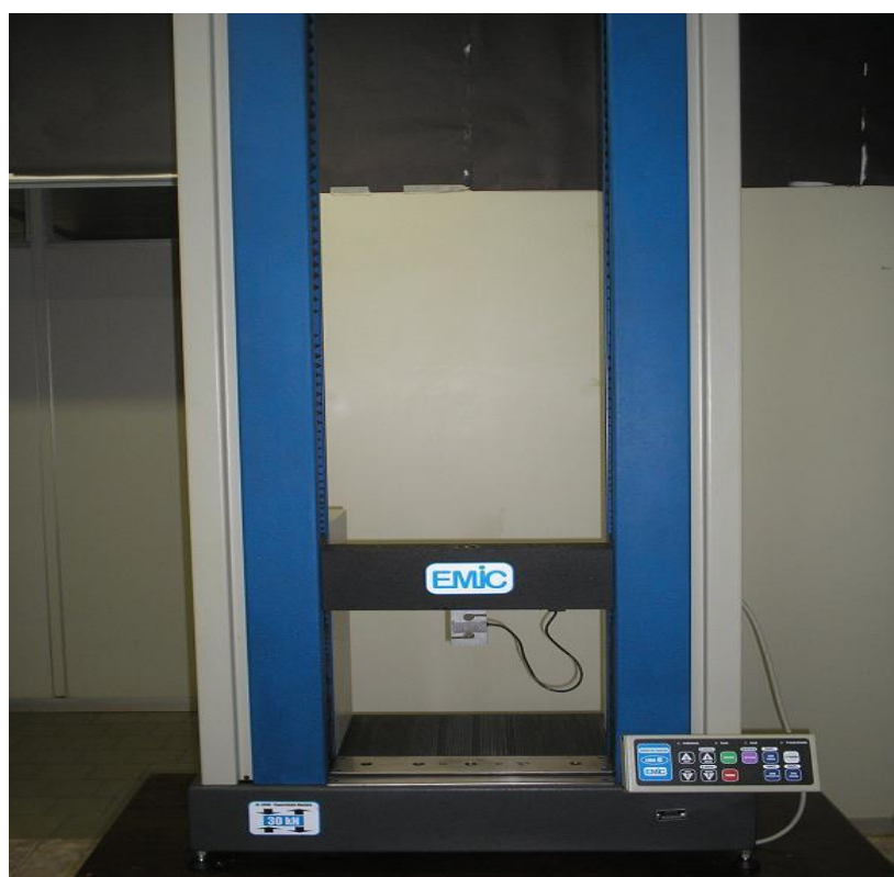
Figura 18 - Máquina Universal de Ensaio EMIC DL 3000 (São Paulo, SP, Brasil) utilizada para aplicação de carga.
