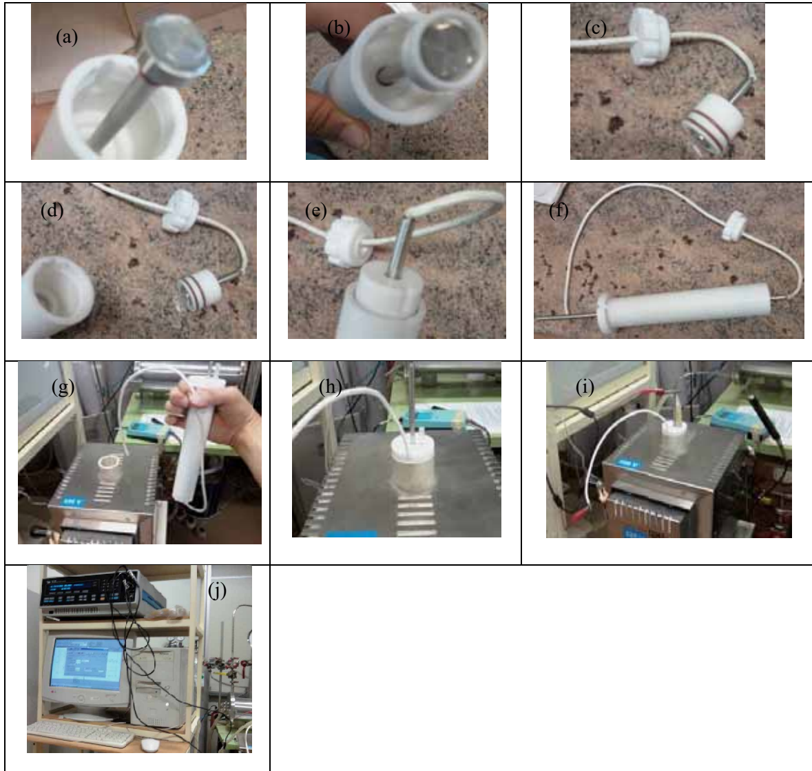
Figura 21 - Acondicionamento de amostra na célula de medida, entre os eletrodos de aço (a-f), célula de medida sendo inserida em abertura do forno (g-h), célula conectada aos “jacarés” (conectores em garra) (i), e Potenciostato Solartron, acoplado ao microcomputador (j).
