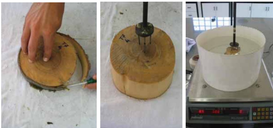
Figura 8 – Retirada da casca, fixação do disco no suporte seguido da imersão em água
