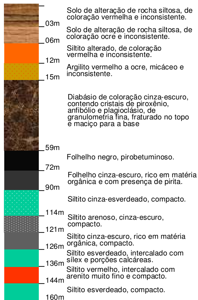
Figura 10 – Descrição litoestratigráfica do poço da Fazenda Areão. Fonte: SONDAGUA Poços Artesianos.
