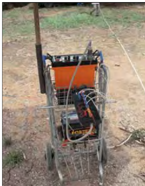
Foto 3 - Equipamento TERRAMETER modelo SAS 4000, cabos e bateria.
