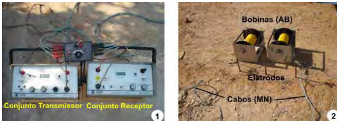
Foto 2 – Equipamento e acessórios para SEV: 1 – conjunto transmissor e receptor; 2 – bobinas AB, eletrodos e cabos MN utilizados na realização dos ensaios de SEV.
