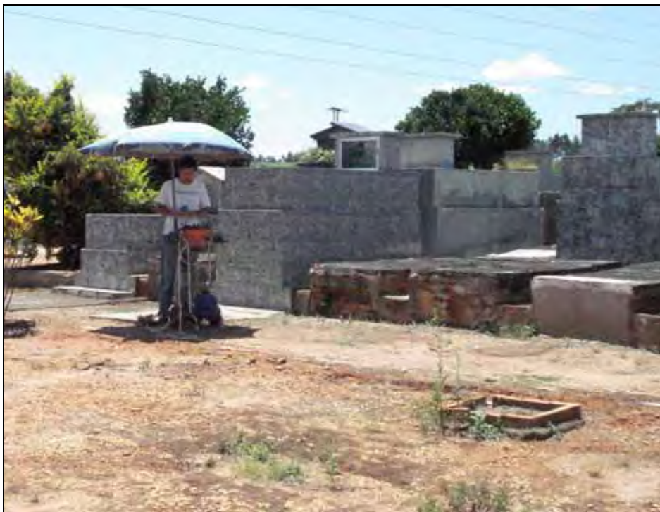
Foto 5 – Execução de uma linha imageamento elétrico 2D no interior do cemitério.
