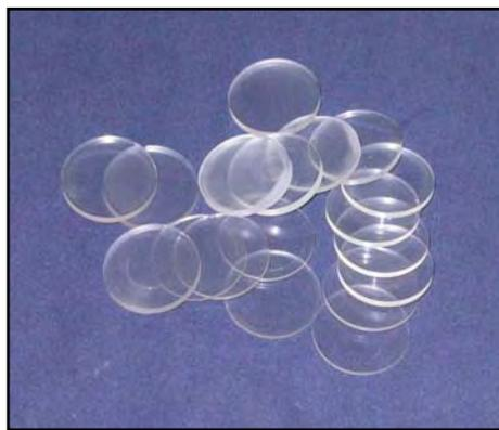
FIGURA 8 - Moldes acrílicos obtidos através de Prensa para Embutimento Metalográfico
