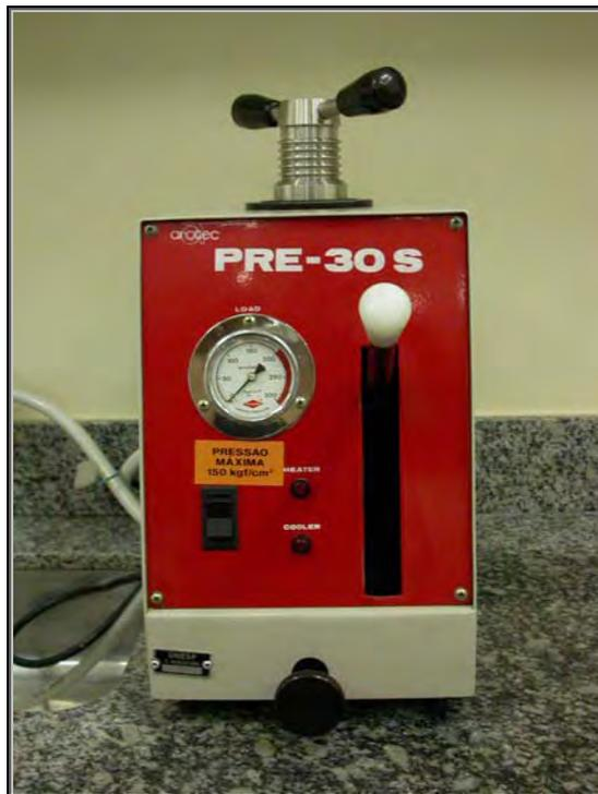
FIGURA 2 - Prensa Semi-automática para Embutimento Metalográfico PRE-30S
