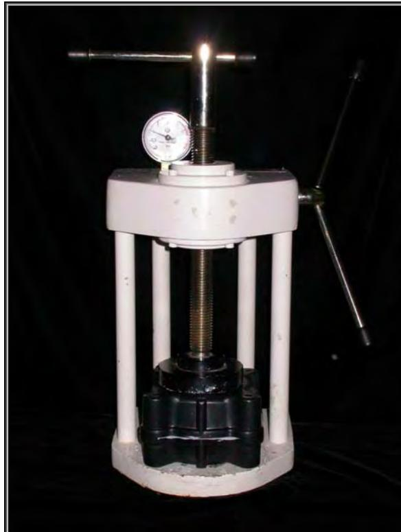
FIGURA 4 - Prensa hidráulica e mufla para microondas
