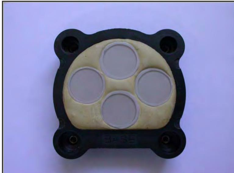
FIGURA 9 - Moldes acrílicos em mufla para microondas
