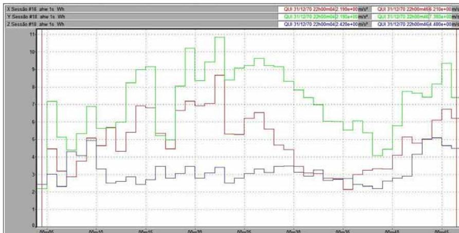
Figura 156 – Vibração no trator New Holland TS 110 no membro superior, em pista de solo firme, com pressão de inflação dos pneus de 20 psi, na marcha II-4.
