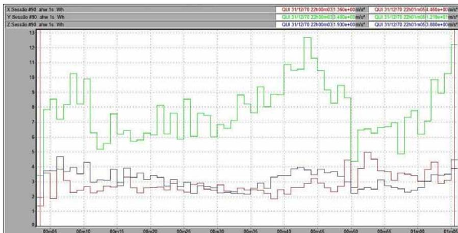
Figura 55 – Vibração no trator New Holland TL 75E no membro superior, em pista de asfalto, com pressão de inflação dos pneus de 15 psi, na marcha II-2.
