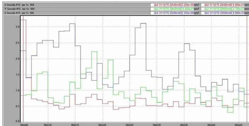
Figura 120 – Vibração no trator New Holland TS 110 no corpo inteiro, em pista de solo batido, com pressão de inflação dos pneus de 20 psi, na marcha II-4.
