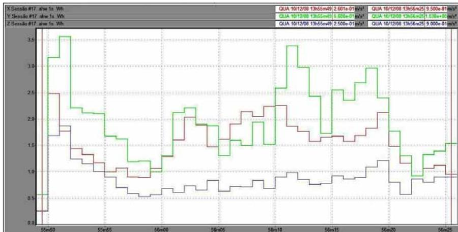
Figura 162 – Vibração no trator New Holland TS 110 no membro superior, em pista de solo firme, com pressão de inflação dos pneus de 30 psi, na marcha II-4.
