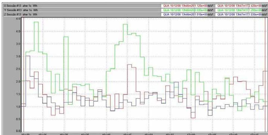
Figura 160 – Vibração no trator New Holland TS 110 no membro superior, em pista de solo firme, com pressão de inflação dos pneus de 30 psi, na marcha II-2.
