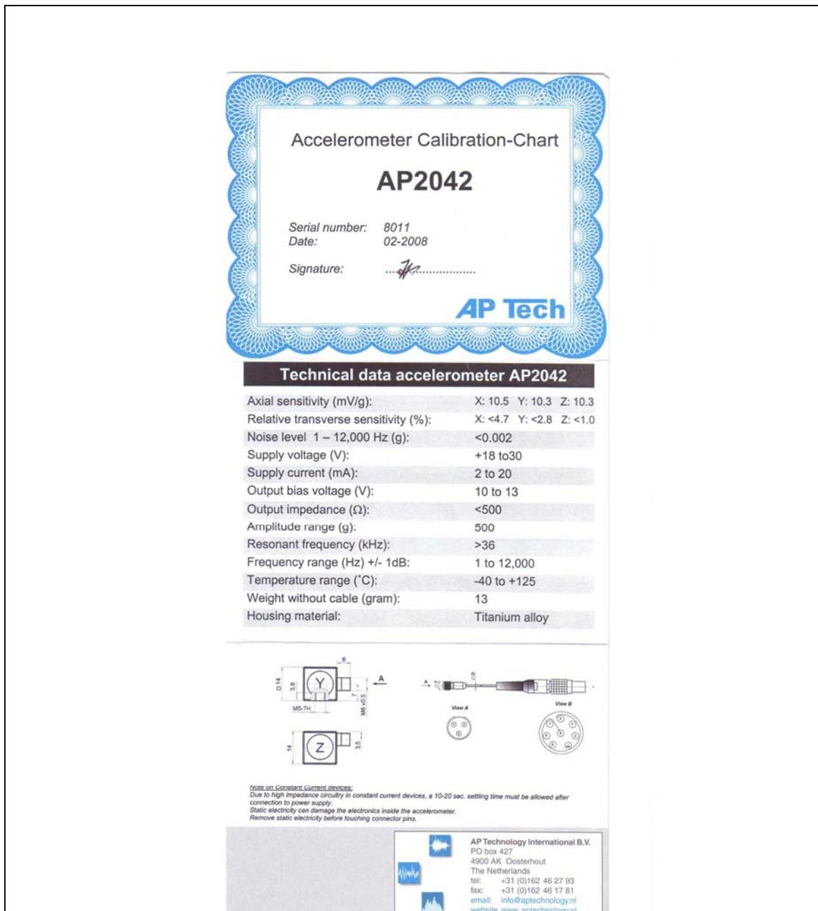
Figura 168– Certificado de calibração do acelerômetro para membros superiores.
