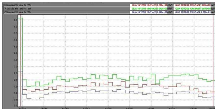
Figura 161 – Vibração no trator New Holland TS 110 no membro superior, em pista de solo firme, com pressão de inflação dos pneus de 30 psi, na marcha II-3.
