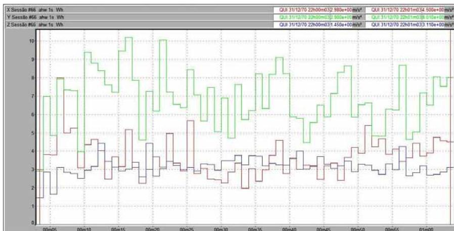
Figura 61 – Vibração no trator New Holland TL 75E no membro superior, em pista de asfalto, com pressão de inflação dos pneus de 25 psi, na marcha II-2.
