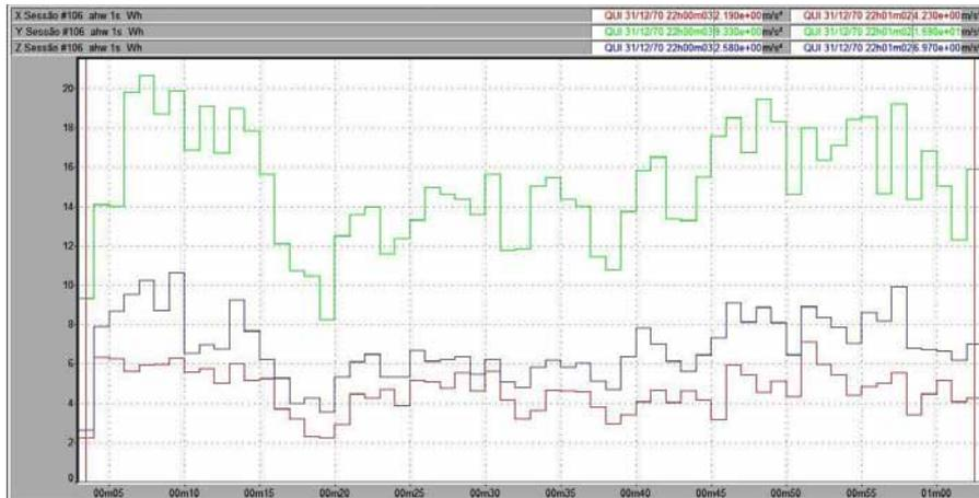
Figura 87 – Vibração no trator New Holland TL 75E no membro superior, em pista de solo firme, com pressão de inflação dos pneus de 25 psi, na marcha II-4.
