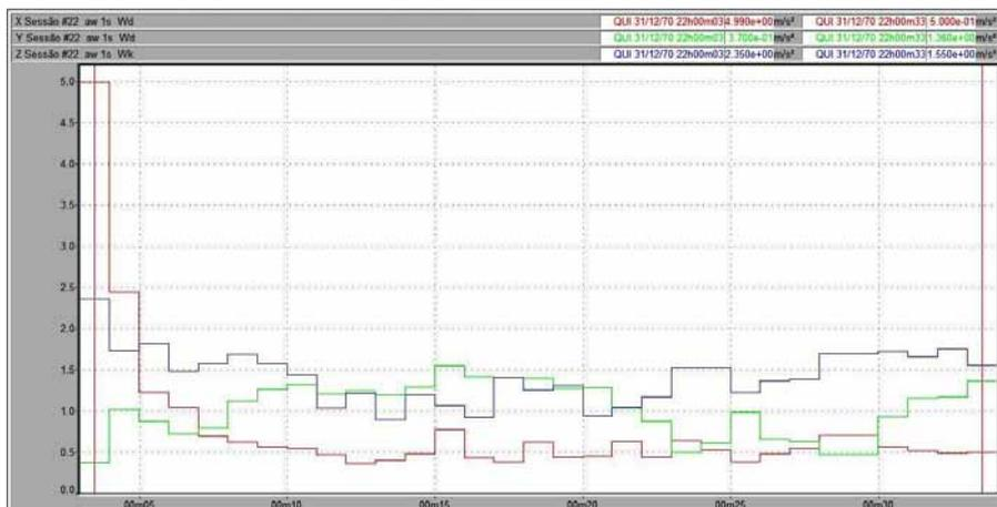
Figura 115 – Vibração no trator New Holland TS 110 no corpo inteiro, em pista de solo batido, com pressão de inflação dos pneus de 15 psi, na marcha II-2.
