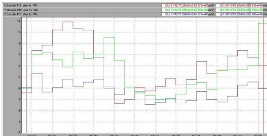
Figura 132 – Vibração no trator New Holland TS 110 no membro superior, em pista de asfalto, com pressão de inflação dos pneus de 20 psi, na marcha II-4.
