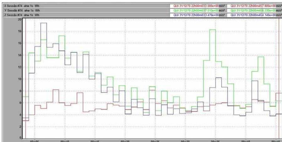
Figura 59 – Vibração no trator New Holland TL 75E no membro superior, em pista de asfalto, com pressão de inflação dos pneus de 20 psi, na marcha II-3.
