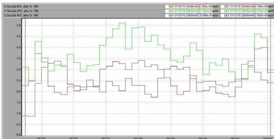
Figura 128 – Vibração no trator New Holland TS 110 no membro superior, em pista de asfalto, com pressão de inflação dos pneus de 15 psi, na marcha II-3.
