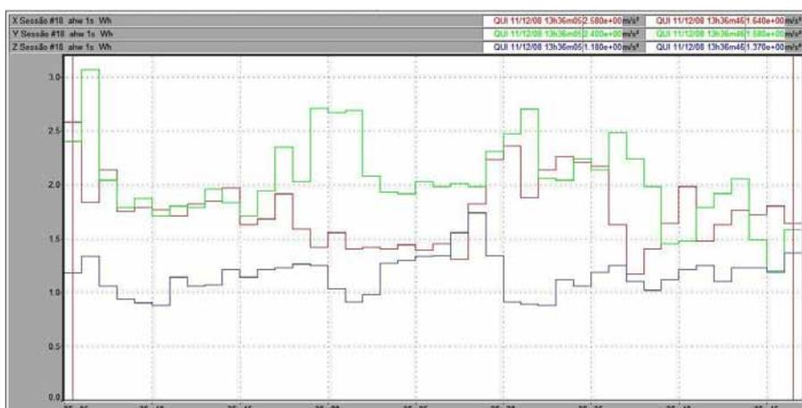
Figura 146 – Vibração no trator New Holland TS 110 no membro superior, em pista de concreto, com pressão de inflação dos pneus de 25 psi, na marcha II-3.
