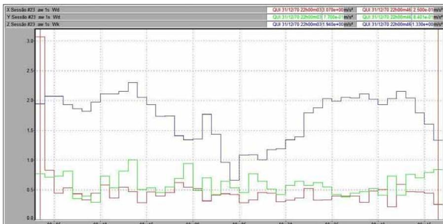
Figura 116 – Vibração no trator New Holland TS 110 no corpo inteiro, em pista de solo batido, com pressão de inflação dos pneus de 15 psi, na marcha II-3.
