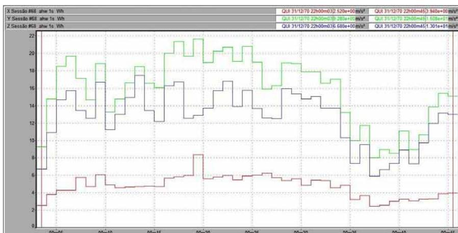
Figura 62 – Vibração no trator New Holland TL 75E no membro superior, em pista de asfalto, com pressão de inflação dos pneus de 25 psi, na marcha II-3.
