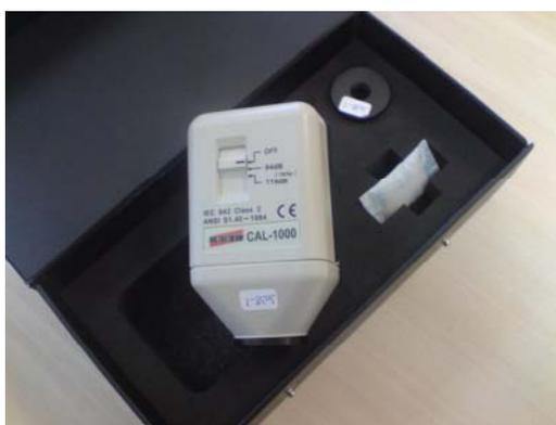
Figura 11 – Calibrador acústico Instrutherm CAL-1000.
