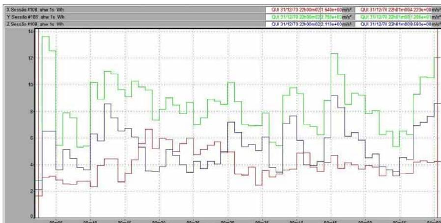
Figura 83 – Vibração no trator New Holland TL 75E no membro superior, em pista de solo firme, com pressão de inflação dos pneus de 20 psi, na marcha II-3.
