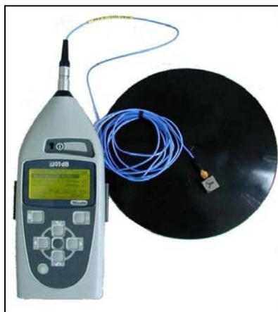
Figura 12 – Medidor de vibração Maestro da 01dB.
