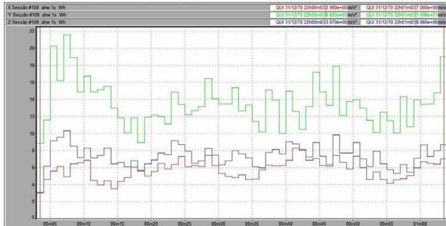
Figura 84 – Vibração no trator New Holland TL 75E no membro superior, em pista de solo firme, com pressão de inflação dos pneus de 20 psi, na marcha II-4.
