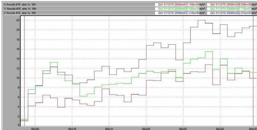
Figura 60 – Vibração no trator New Holland TL 75E no membro superior, em pista de asfalto, com pressão de inflação dos pneus de 20 psi, na marcha II-4.
