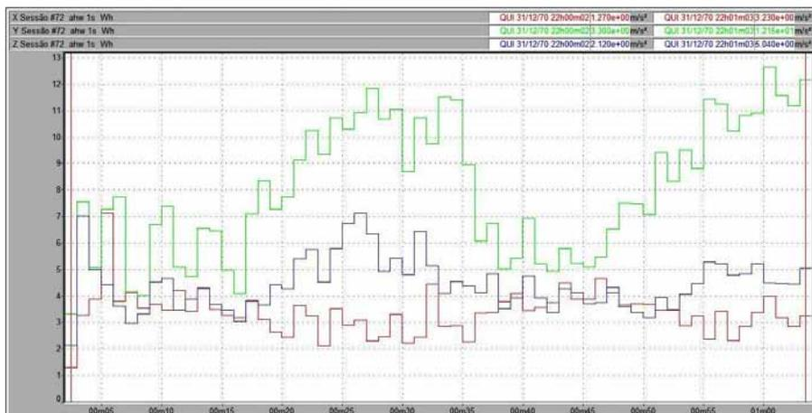
Figura 58 – Vibração no trator New Holland TL 75E no membro superior, em pista de asfalto, com pressão de inflação dos pneus de 20 psi, na marcha II-2.
