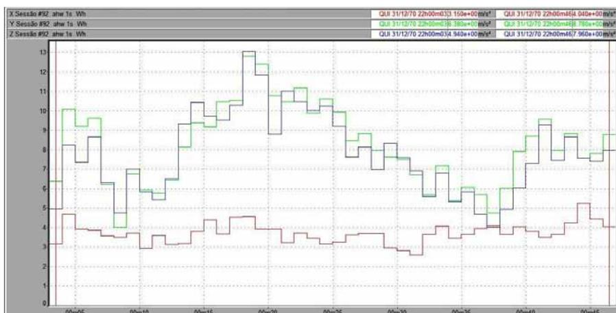
Figura 56 – Vibração no trator New Holland TL 75E no membro superior, em pista de asfalto, com pressão de inflação dos pneus de 15 psi, na marcha II-3.
