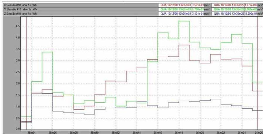
Figura 138 – Vibração no trator New Holland TS 110 no membro superior, em pista de asfalto, com pressão de inflação dos pneus de 30 psi, na marcha II-4.
