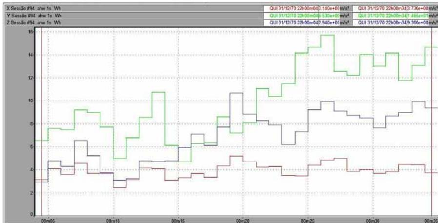
Figura 57 – Vibração no trator New Holland TL 75E no membro superior, em pista de asfalto, com pressão de inflação dos pneus de 15 psi, na marcha II-4.
