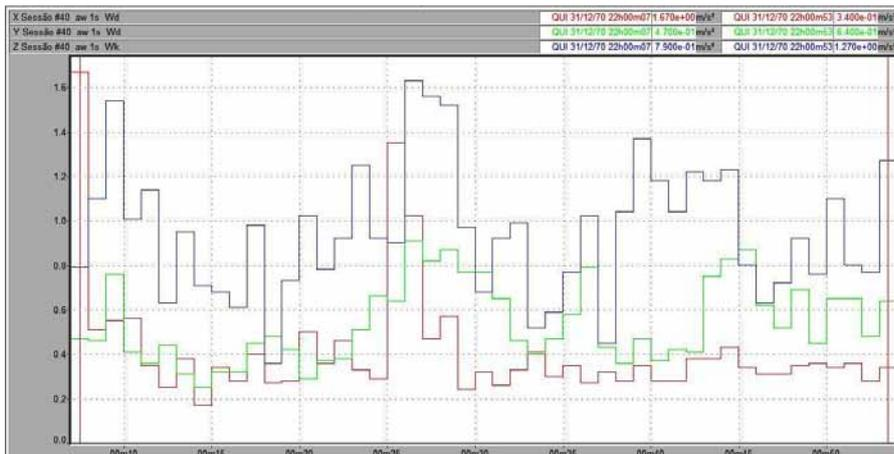
Figura 53 – Vibração no trator New Holland TL 75E no corpo inteiro, em pista de solo firme, com pressão de inflação dos pneus de 30 psi, na marcha II-3.
