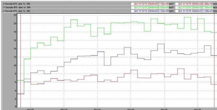
Figura 63 – Vibração no trator New Holland TL 75E no membro superior, em pista de asfalto, com pressão de inflação dos pneus de 25 psi, na marcha II-4.
