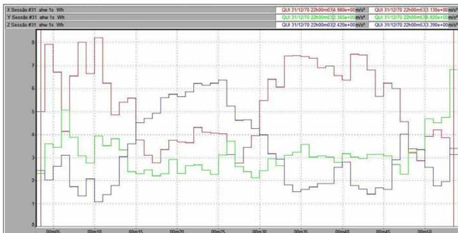
Figura 127 – Vibração no trator New Holland TS 110 no membro superior, em pista de asfalto, com pressão de inflação dos pneus de 15 psi, na marcha II-2.
