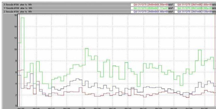
Figura 85 – Vibração no trator New Holland TL 75E no membro superior, em pista de solo firme, com pressão de inflação dos pneus de 25 psi, na marcha II-2.
