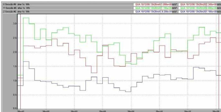
Figura 137 – Vibração no trator New Holland TS 110 no membro superior, em pista de asfalto, com pressão de inflação dos pneus de 30 psi, na marcha II-3.
