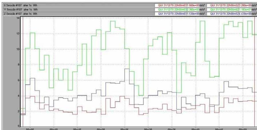
Figura 82 – Vibração no trator New Holland TL 75E no membro superior, em pista de solo firme, com pressão de inflação dos pneus de 20 psi, na marcha II-2.
