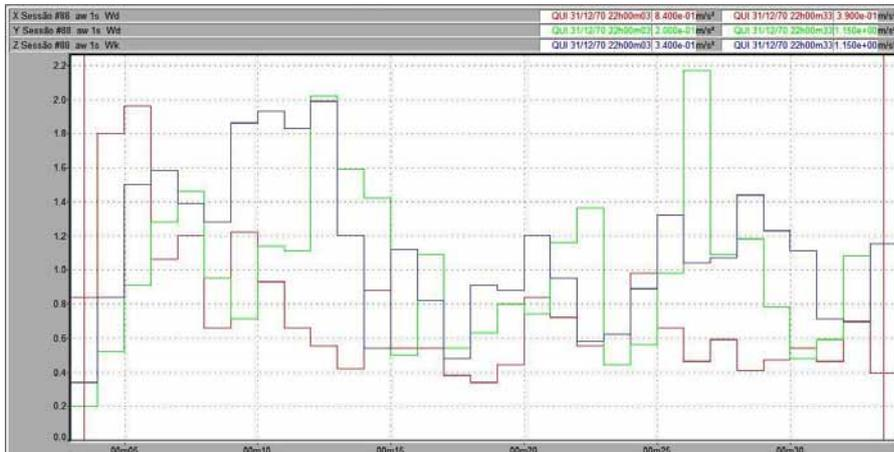
Figura 21 – Vibração no trator New Holland TL 75E no corpo inteiro, em pista de asfalto, com pressão de inflação dos pneus de 15 psi, na marcha II-4.
