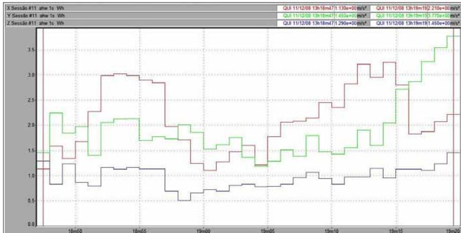
Figura 159 – Vibração no trator New Holland TS 110 no membro superior, em pista de solo firme, com pressão de inflação dos pneus de 25 psi, na marcha II-4.
