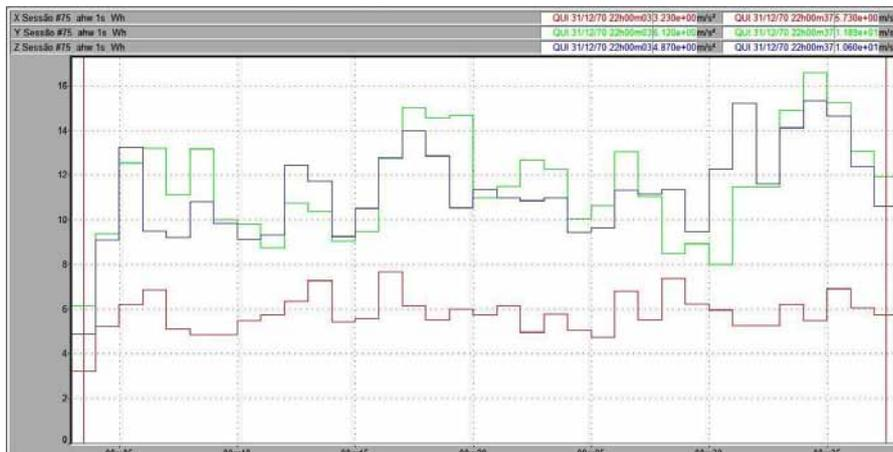
Figura 72 – Vibração no trator New Holland TL 75E no membro superior, em pista de concreto, com pressão de inflação dos pneus de 20 psi, na marcha II-4.
