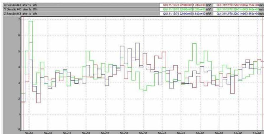
Figura 88 – Vibração no trator New Holland TL 75E no membro superior, em pista de solo firme, com pressão de inflação dos pneus de 30 psi, na marcha II-2.
