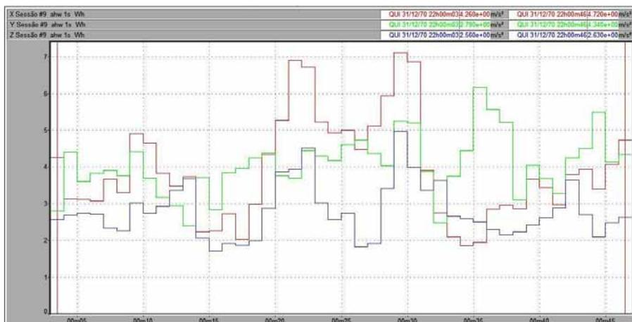
Figura 143 – Vibração no trator New Holland TS 110 no membro superior, em pista de concreto, com pressão de inflação dos pneus de 20 psi, na marcha II-3.
