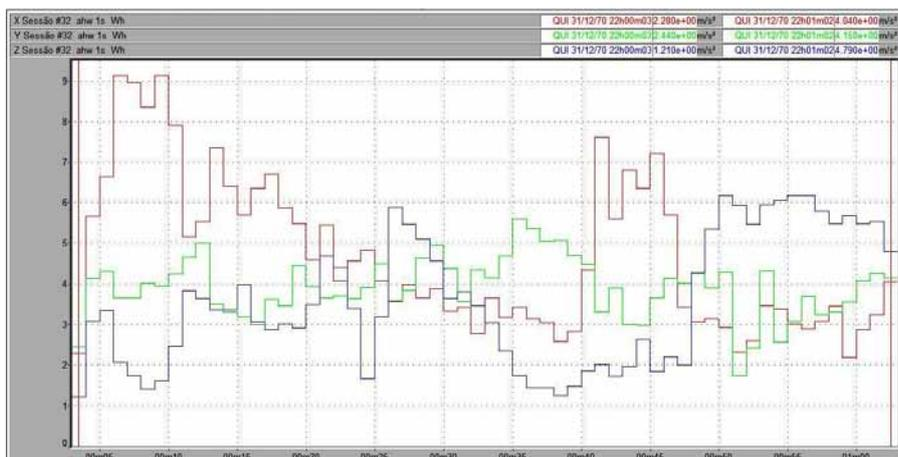
Figura 139 – Vibração no trator New Holland TS 110 no membro superior, em pista de concreto, com pressão de inflação dos pneus de 15 psi, na marcha II-2.
