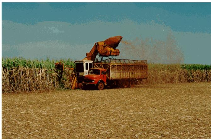
**Figura 6:** Colheita mecanizada da cana crua.
