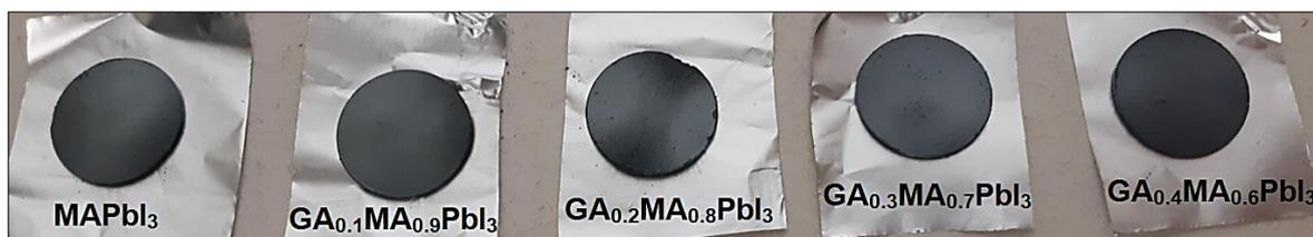
Figura 2.1 - Pastilhas sinterizadas de  $GA_xMA_{1-x}PbI_3$ .
