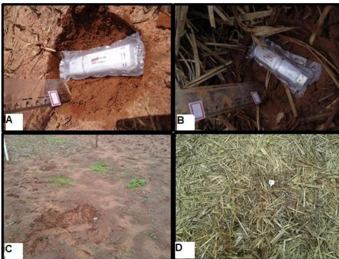
**Figura 2** A) Termometro a 2 cm sem palha; B) Termometro a 2 cm com toneladas de palha; C) Termometro a 2 cm sem palha após o fechamento da trincheira com o solo; D) Termometro a 2cm com toneladas de palha após o fechamento com a palha.
