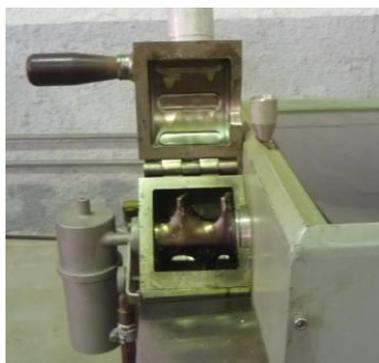
Figura 8 - Cápsula de mistura do homogeneizador de plásticos.
