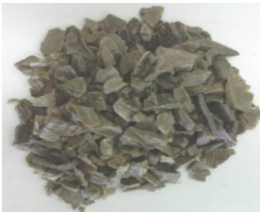
Figura 14 - Material compósito triturado, obtido através da fusão do Poliestireno Expandido reforçado com 15% em massa de fibras de algodão.
