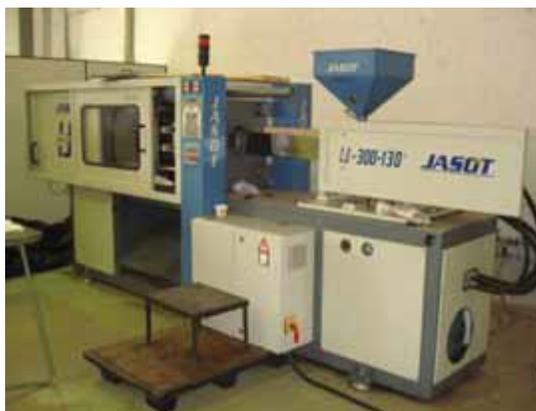
Figura 11 - Máquina injetora de plásticos
