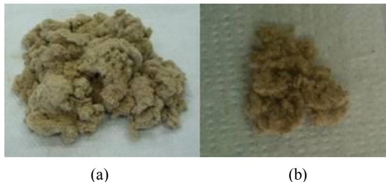
Figura 13 - Fibras de algodão: (a) antes da limpeza (b) após lavagem e filtragem
