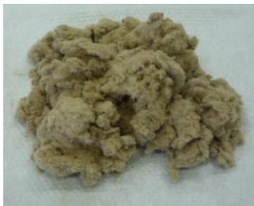
Figura 6 - Fibra de algodão descartada pela indústria têxtil antes da limpeza.
