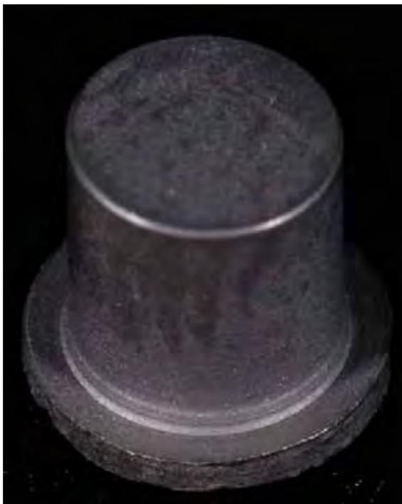
FIGURA 7 - Padrão metálico após o tratamento superficial com jateamento com óxido de alumínio.
