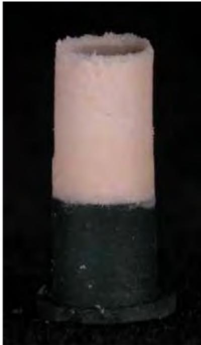
FIGURA 17 - Corpo-de-prova após a remoção do dispositivo de *teflon*.
