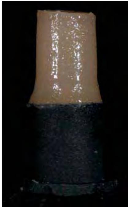
FIGURA 18 - Corpo-de-prova após sinterização da primeira etapa de cerâmica de dentina.
