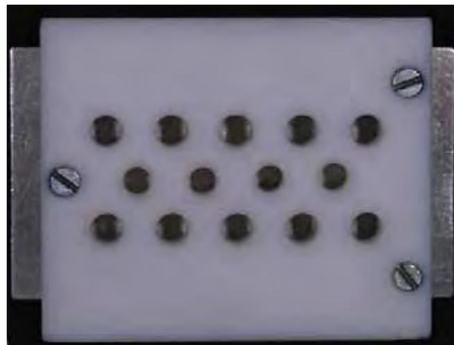
FIGURA 15 – Dispositivo para aplicação das camadas de cerâmica.
