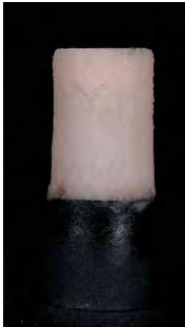
FIGURA 19 - Corpo-de-prova pronto para a segunda sinterização.
