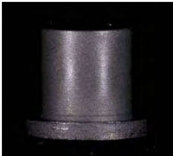
FIGURA 5 - Estrutura metálica do cp após jateamento total com óxido de alumínio.
