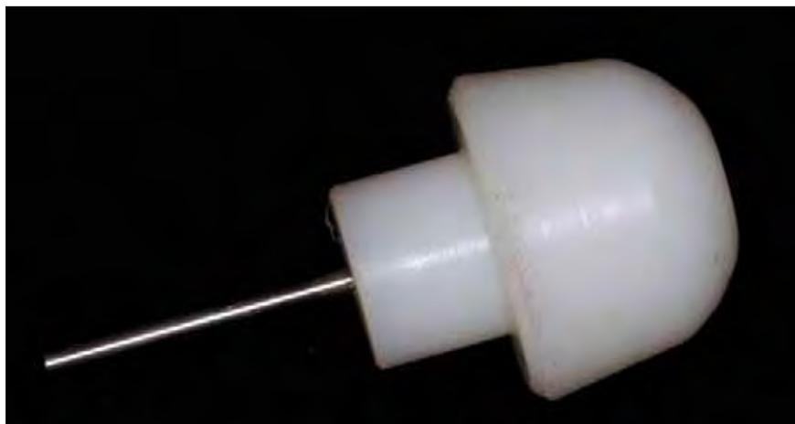
FIGURA 16 - Êmbolo metálico utilizado para remover o corpo-de-prova do dispositivo de *teflon*.
