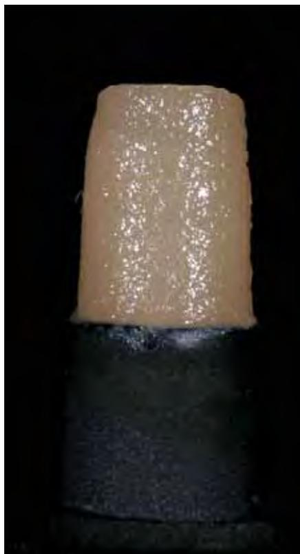
FIGURA 20 - Corpo-de-prova após a segunda sinterização e pronto para o ensaio mecânico de cisalhamento.
