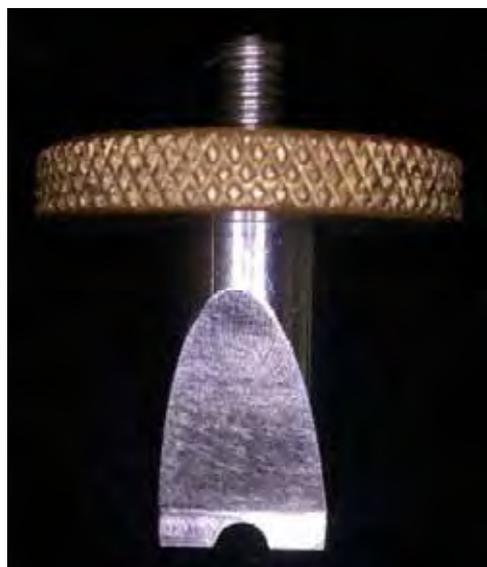
FIGURA 21 - Dispositivo faca com entalhe.
