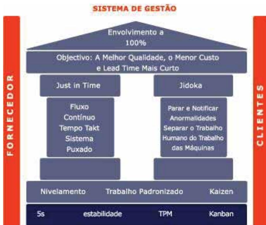
**Figura 1:** Representação esquemática dos pilares Lean.
