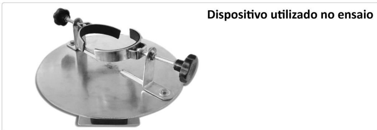
Figura 20. Dispositivo utilizado na avaliação da força de torque para abertura das embalagens.
