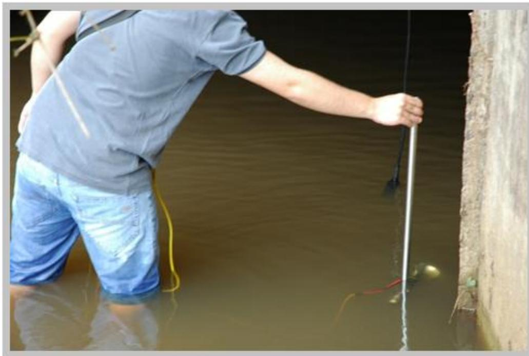
Figura 14. Medição da vazão através do molinete fluviométrico Newton.
