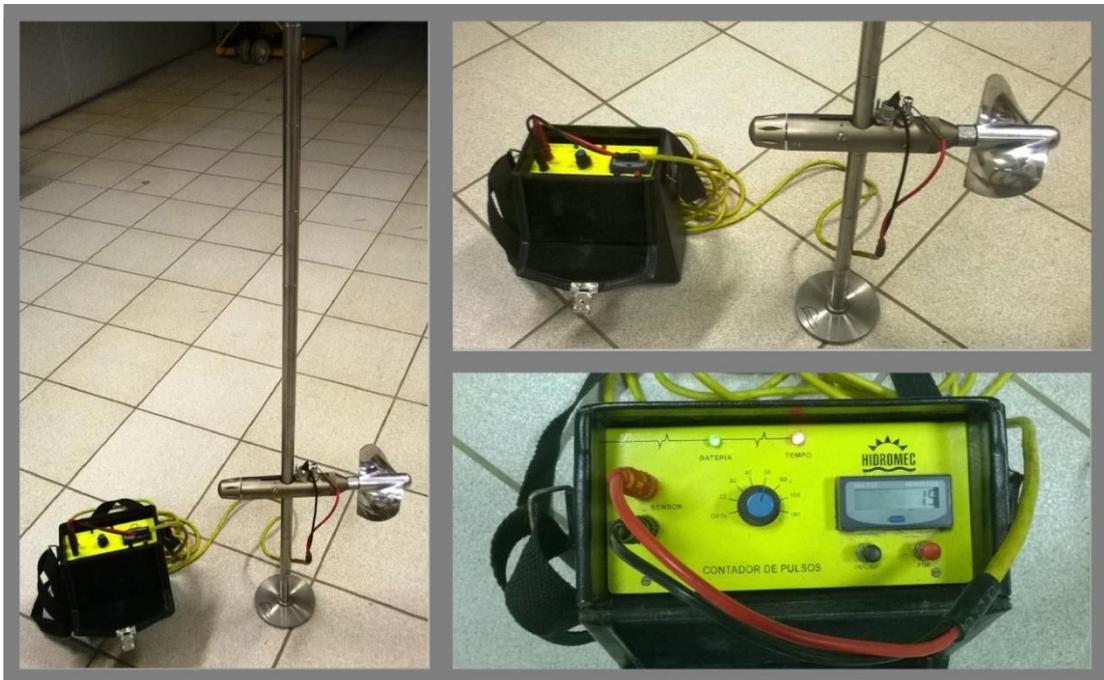
Figura 13. Molinete fluviométrico Newton.
