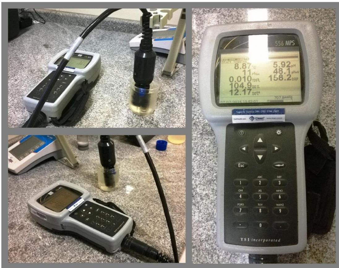
Figura 15. Medição do STD através da Sonda Multiparâmetros YSI 556 MPS.
