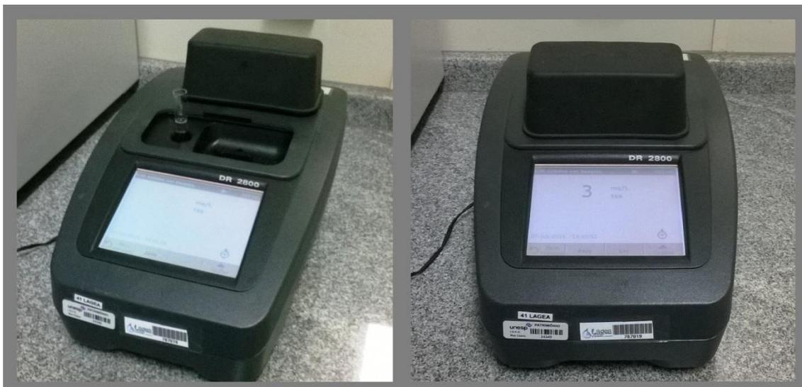
Figura 17. Medição do STS através do Espectrofotômetro Hach DR 2800.
