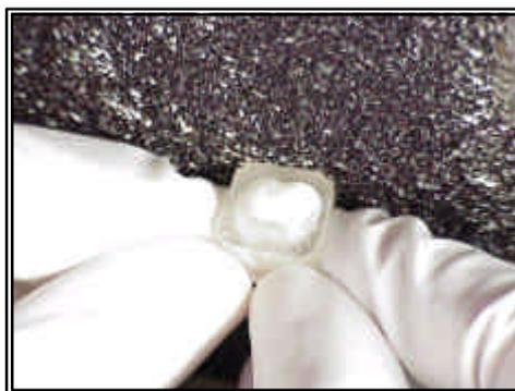
Figura 1B - Recorte do corpo de prova no recortador de gesso
