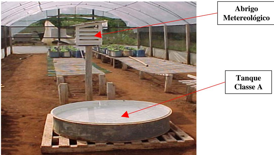
**Figura 1.** Panorâmica da estufa e visão do Tanque Classe A e posto de coleta de temperaturas.
