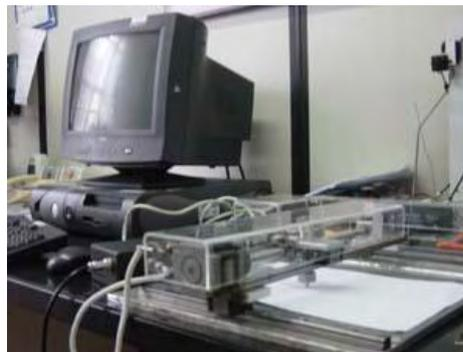
Figura 9: Traçador gráfico acoplado a um microcomputador
