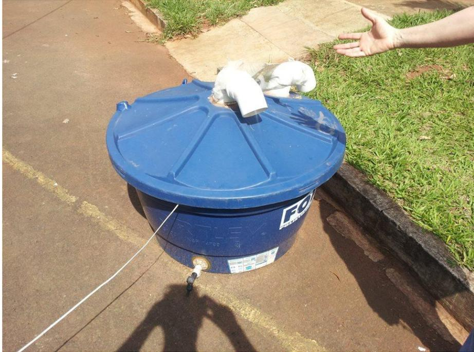
**Figura 9:** Caixa de água com aquecimento para evaporar água.
