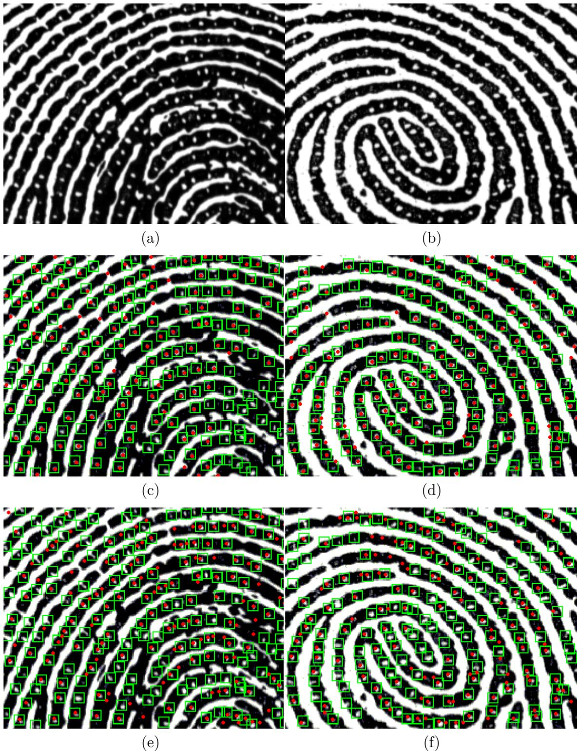
**Figura 5.1:** Comparativo da detecção de poros dos dois métodos avaliados em duas imagens de 1000 dpi da base de dados UNESP-FSDB. (a)-(b) Imagens originais, (c)-(d) Resultado da detecção de poros utilizando método baseado em filtros adaptativos, e (e)-(f) Resultado da detecção de poros utilizando método baseado em filtros isotrópicos. Os poros detectados estão em destaque na cor vermelha e os poros do conjunto verdade estão denotados pelas caixas delimitadoras 10x10 na cor verde.
