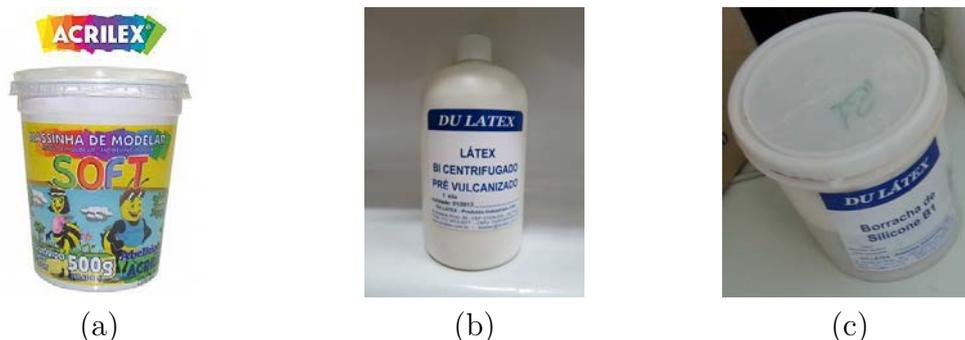
**Figura 4.2:** Materiais utilizados para criação da base de dados UNESP-FSDB. (a) Massa de modelar SOFT da marca ACRILEX, (b) Látex da marca DU LÁTEX e (c) Borracha de Silicone B1 Bege da marca DU LÁTEX.
