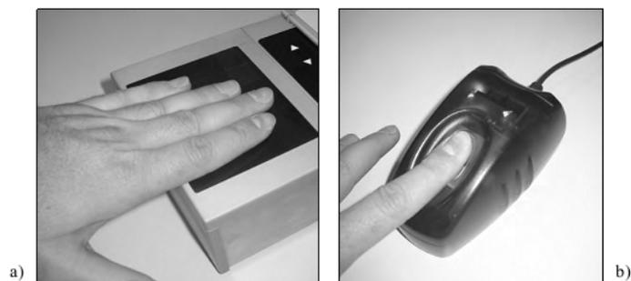
**Figura 2.5:** Sensores de impressões digitais. a) Captura simultânea de 4 dedos um sensor multi-dedos. b) Captura com um sensor de apenas um dedo. Adaptado de (Jain & Maltoni, 2009).
