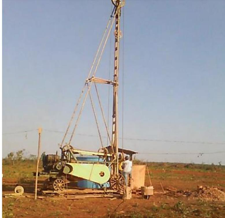
Figura 7-Equipamento para perfuração de poço. Foto: Fabrício Bueno. Banco de Imagens da ANA.
