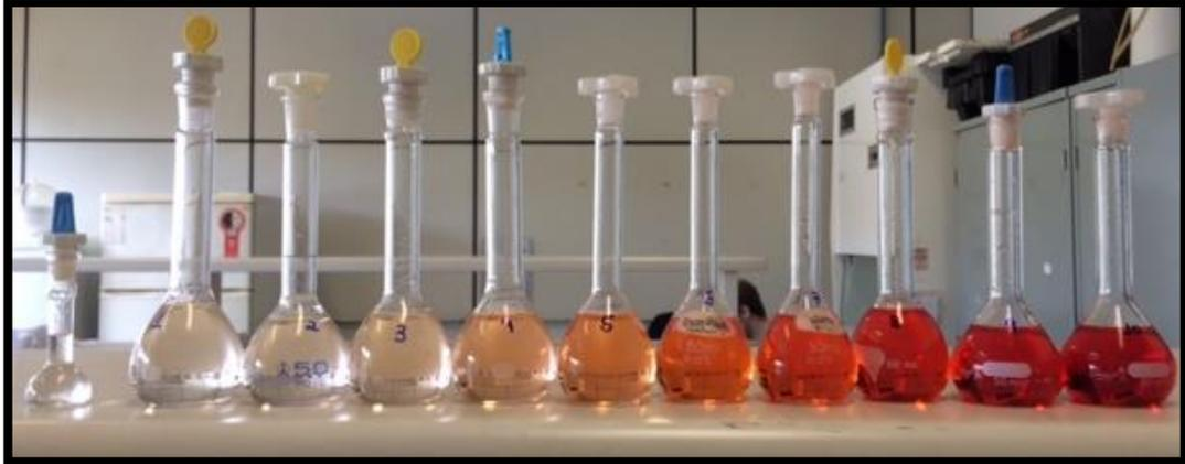
Figura 14-Imagem dos balões volumétricos da curva padrão, contendo distintas concentrações de  $\text{Fe}^{2+}$
