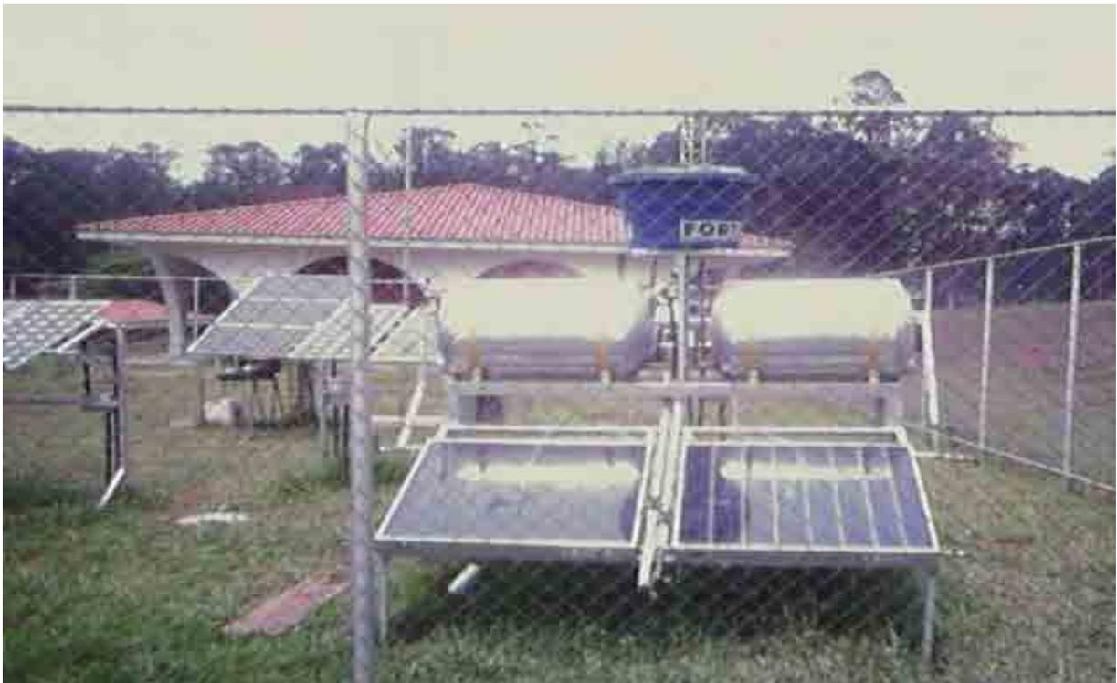
Figura 7 – Vista frontal do coletor solar plano
