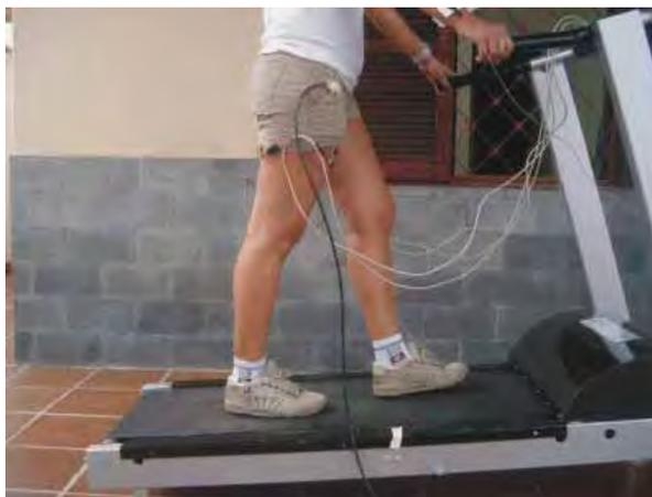
Figura 1.19 - Esteira instrumentada com plataforma de força: aplicação em análise de marcha (EMG System do Brasil ®).
