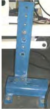
Figura 2.6 – Suporte para inclinação da esteira
