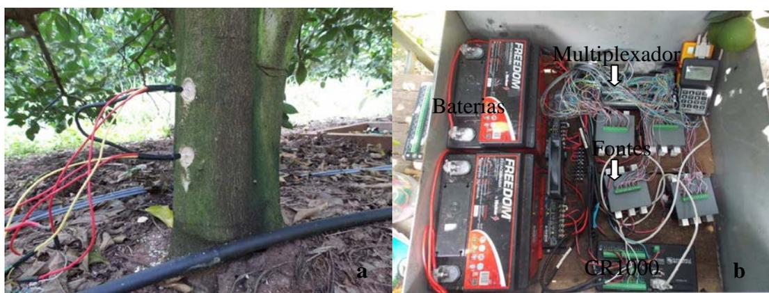
**Figura 8.** a) sensores de fluxo de seiva instalados no tronco das laranjeiras; b) sistema de fornecimento de energia (baterias e fontes), coleta e armazenamento de dados (multiplexador e CR1000). Itatinga – SP.
