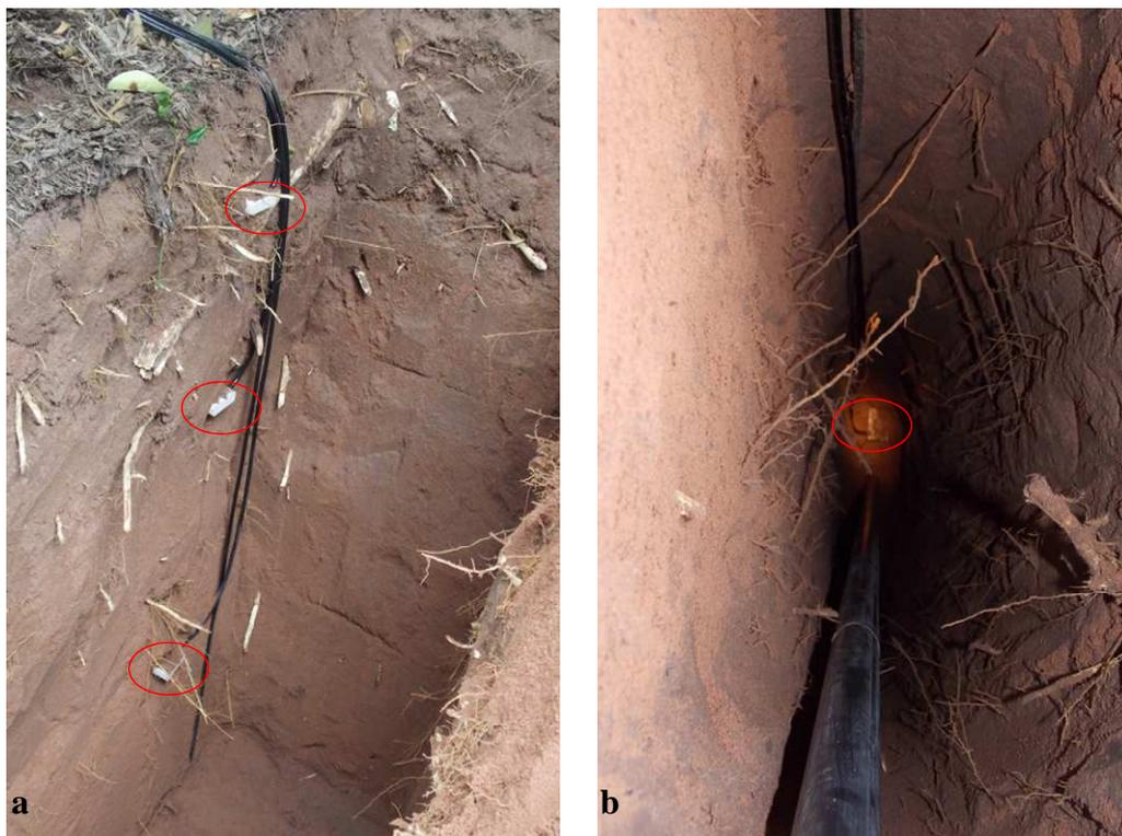
**Figura 5.** a) Sensores de umidade do solo (TDR Mintrase, Soil moisture USA), instalados no perfil do solo por meio da abertura de trincheiras no pomar de laranja ‘Valência’; b) detalhe do sensor TDR instalado a 5 m de profundidade. Itatinga – SP.
