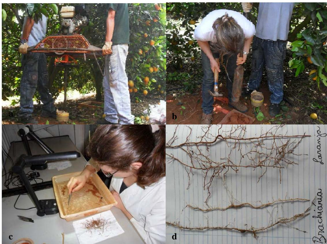
**Figura 2.** a) Coleta de solo com trado motorizado para amostragem de raízes finas; b) detalhe da broca de coleta de solo; c) separação de raízes finas para determinação da massa seca e área de raízes; d) detalhe das raízes de laranjeira e de braquiária. Itatinga – SP.
