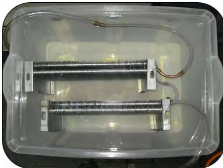
Figura 33 – Montagem do condensador
