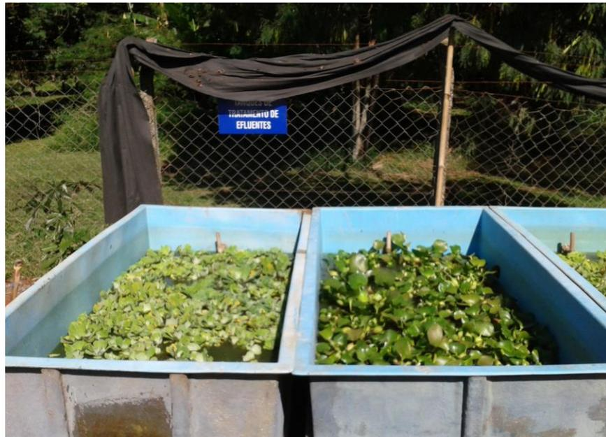
**Figura 1.** Sistema de tratamento de efluentes com macrófitas aquáticas alface d' água (*P. stratiotes*) e aguapé (*E. crassipes*).
