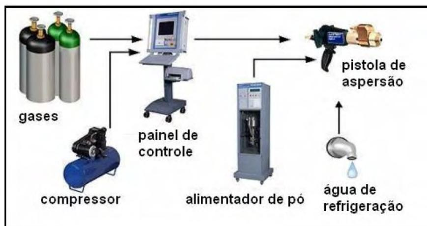
**Figura 15** - Esquema do sistema de aspersão térmica a chama oxicom bustível de alta velocidade (HVOF DJH 2700 da Sulzer Metco).
