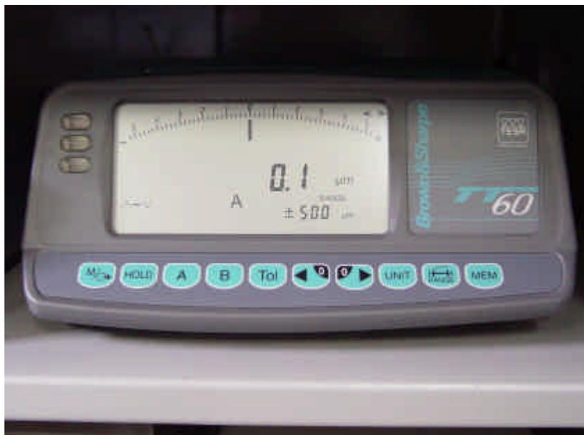
Figura 4-18 - Módulo TT60 usado no teste de agressividade.
