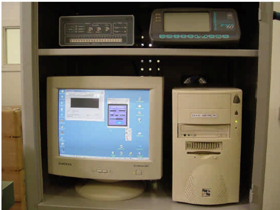
Figura 4-3 - Sistema de aquisição de dados.
