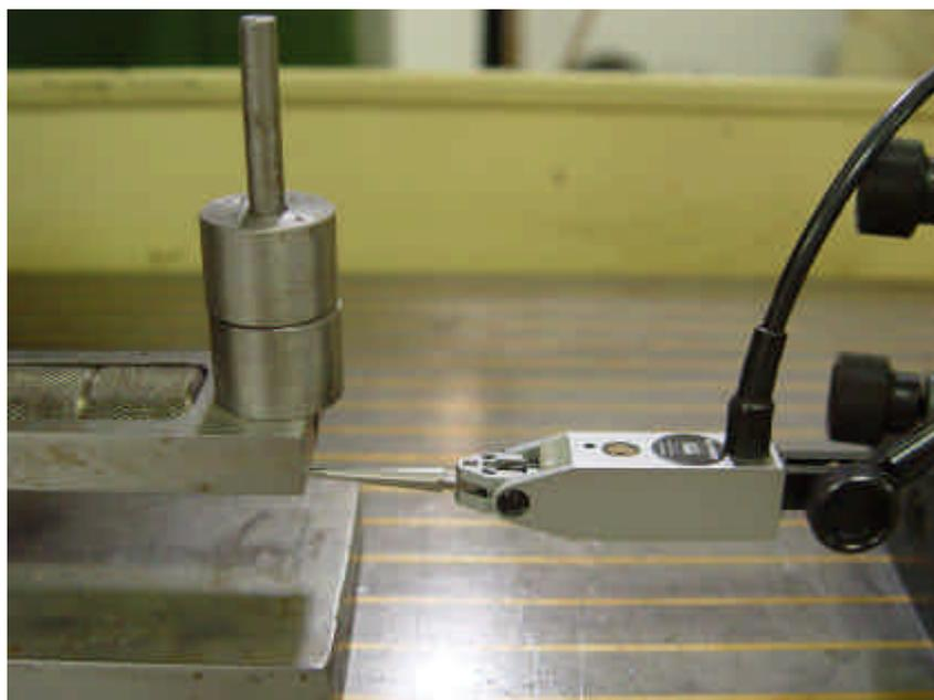
Figura 4-17 - Sensor de deslocamento utilizado no teste de agressividade.
