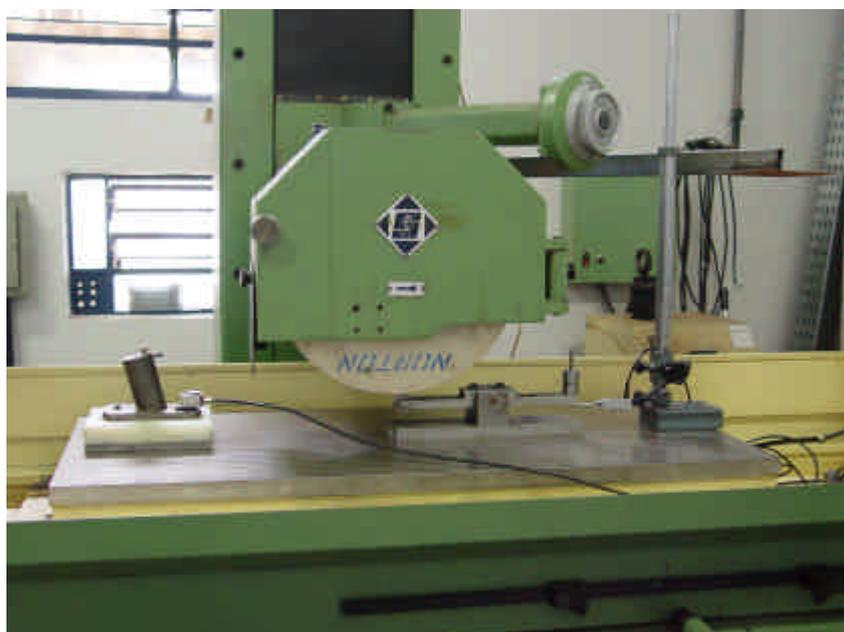
Figura 4-10 – Banco de ensaios, dressador e balança de agressividade.
