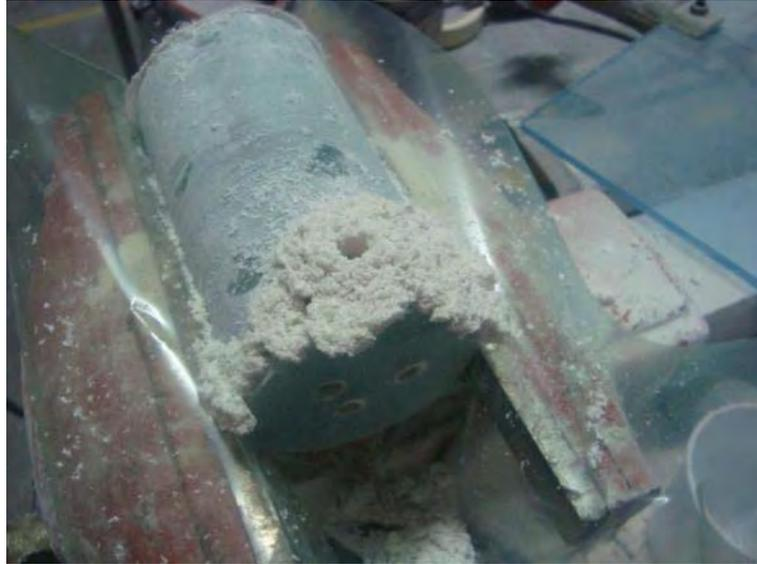
Figura 5 - Material com furos paralelos ( $0^\circ$ ) e perpendiculares ( $90^\circ$ ) ao eixo.
