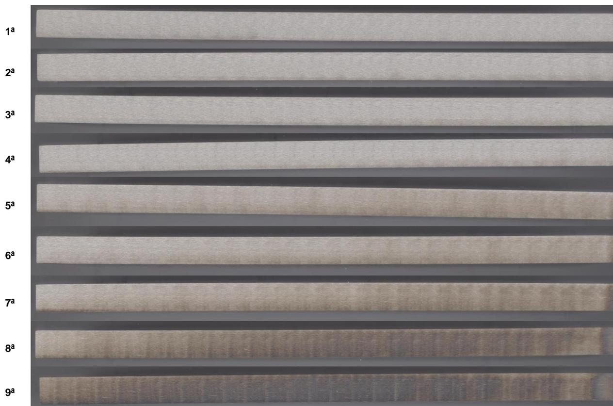
**Figura 23.** Inspeção visual das superfícies das peças retificadas do VC 131.
