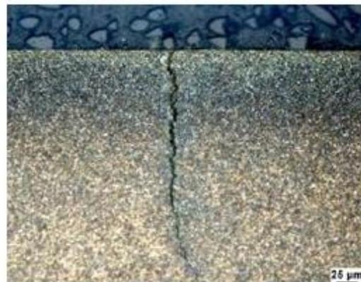
**Figura 10.** Trinca após processo de retificação - aço SAE 52100 (INA, 2009).
