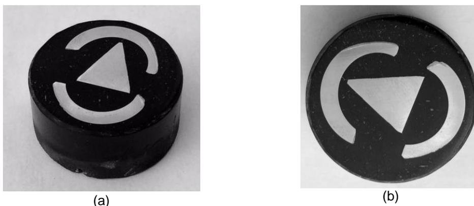
**Figura 20.** Amostra embutida no baquelite, (a) vista lateral e (b) vista superior.
