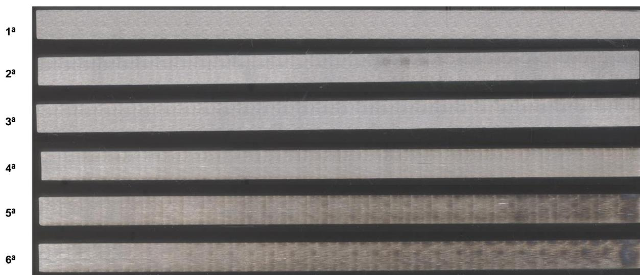
**Figura 29.** Inspeção visual das superfícies das peças retificadas do ABNT 1045.
