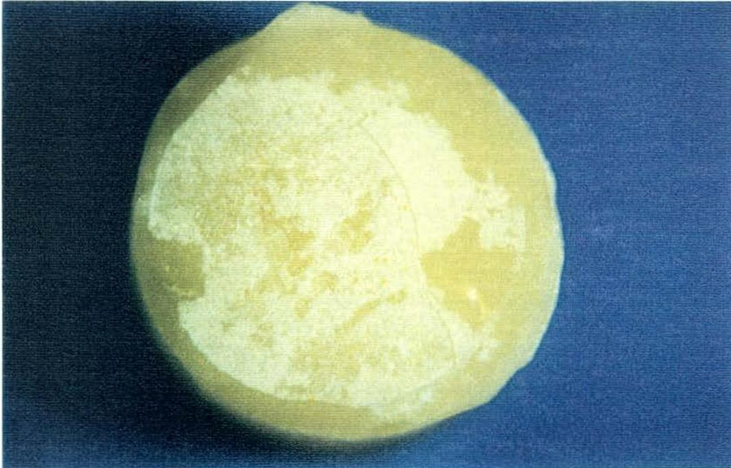
FIGURA 30 - Fratura mista. Superfície do material.
