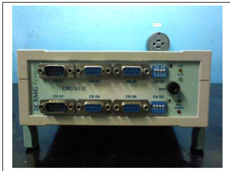
Figura 23 - Vista frontal do eletromiógrafo EMG System modelo EMG 611C.
