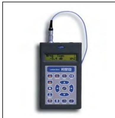
Figura 21 - Medidor de vibração do corpo humano HVM-100.
