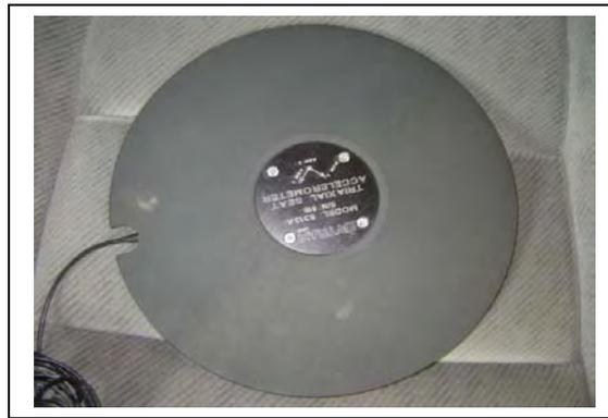
Figura 22 - Acelerômetro tipo almofada tri axial SENO 27-CBL.
