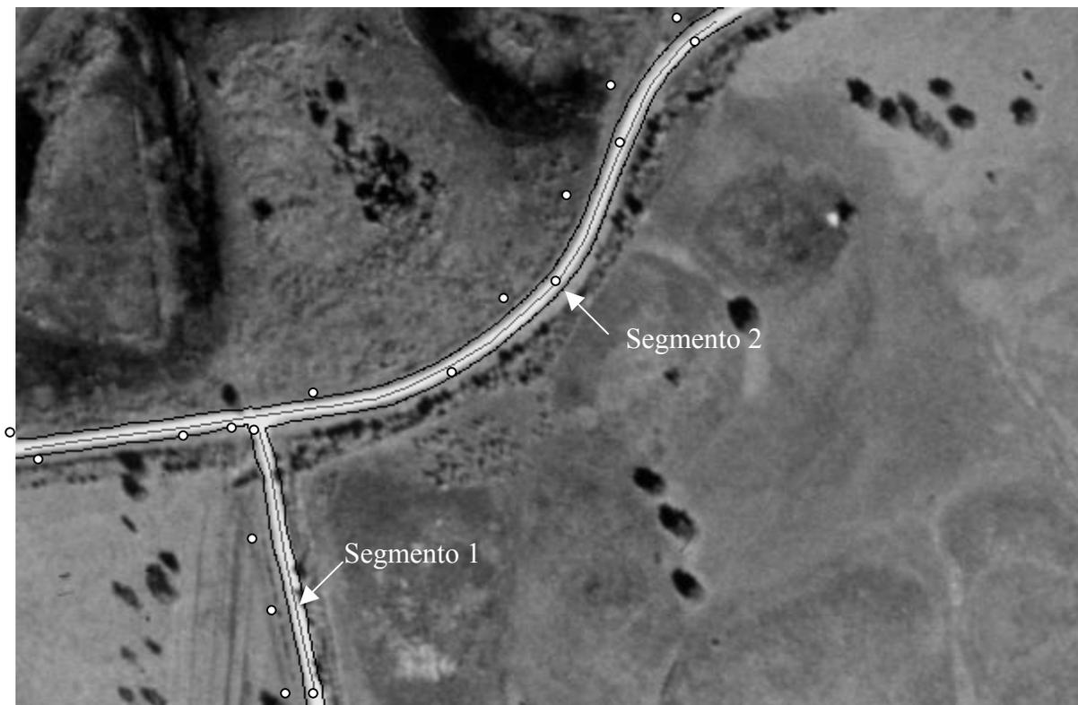
**FIGURA 4.8** – Resultado obtido com a imagem real 4 na extração de bordas pelo método baseado em *snakes*.
