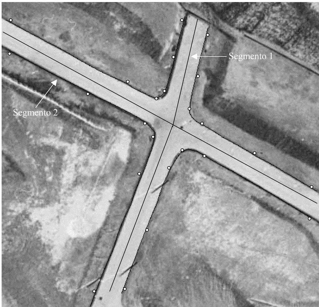
**FIGURA 4.12** – Extração de bordas realizada pelo método *snakes*
