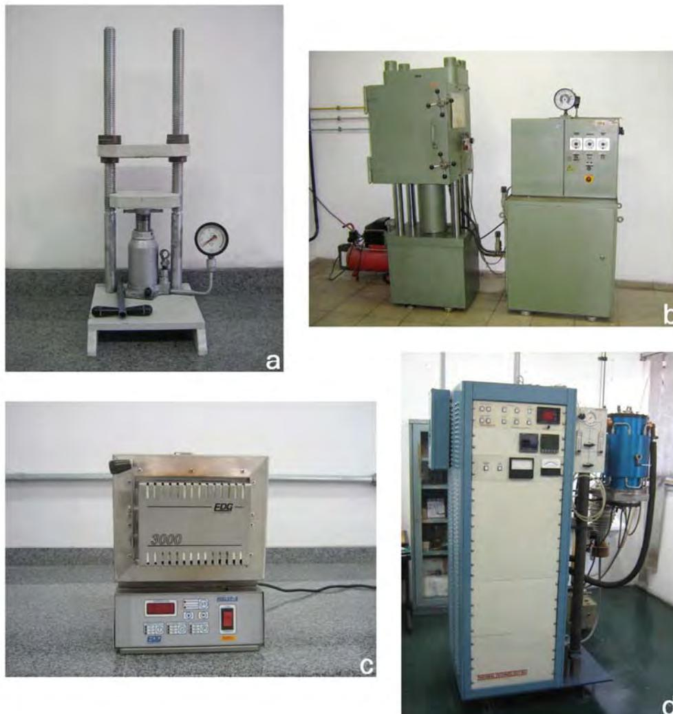
Figura 3 - Equipamentos utilizados na confecção dos implantes: a) prensa hidráulica uniaxial; b) prensa isostática; c) forno EDG 3000; d) forno a vácuo para sinterização.
