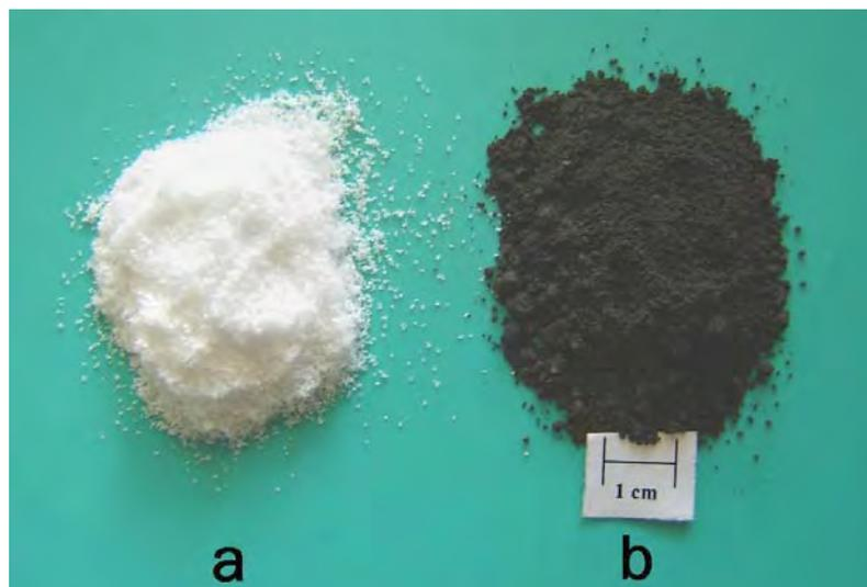
Figura 1 - Materiais utilizados na confecção dos implantes: a) uréia em grânulos com diâmetro entre 177 a 250  $\mu\text{m}$ ; b) pó de titânio com granulometria de 8  $\mu\text{m}$ .
