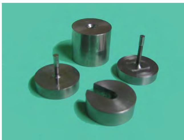
Figura 2 - Matriz de aço, medindo 6,0 mm x 3,5 mm, utilizada para fabricação das amostras de titânio.
