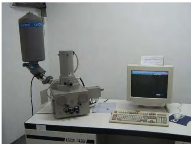
Figura 8 - Microscópio eletrônico de varredura acoplado ao espectrômetro de energia dispersiva.
