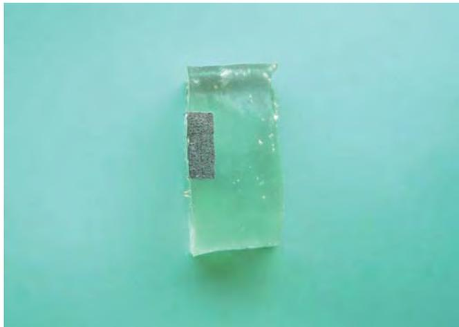
Figura 5 - Bloco de resina hemisseccionado, contendo amostra porosa de titânio polida na face de corte.
