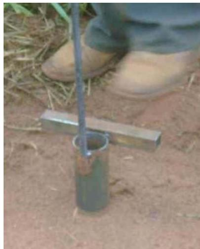
Figura 2 – Coletor utilizado durante a amostragem de solo para a avaliação do banco de sementes.
