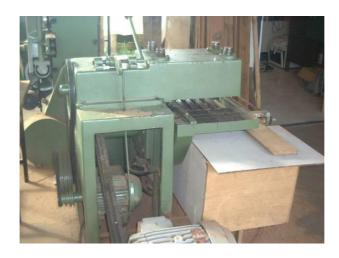
Figura 3. 2- Serra circular multilâminas, empregada para geração de peças na forma de sarrafos (ALVES, 2012).
