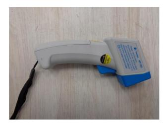
Figura 3. 15- Termômetro utilizado para determinar a temperatura dos adesivos.
