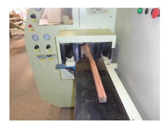
Figura 3. 20- Fresadora utilizada na geração das superfícies de colagem das peças.
