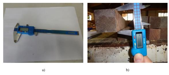
Figura 3. 12- a) Paquímetro e b) medidas das dimensões do sarrafo.
