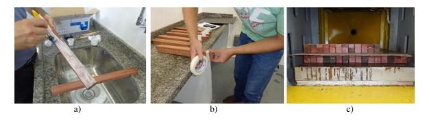
Figura 3. 23- Etapas da colagem e a prensagem das peças: a) e b) etapas da colagem, c) peças sendo preparadas para serem prensadas.
