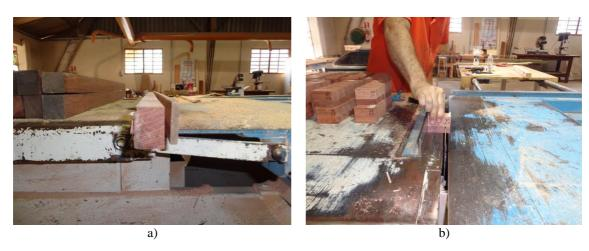
Figura 3. 5- Serra circular esquadrejadeira - a) corte longitudinal e b) corte transversal.
