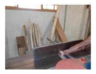
Figura 3. 3– Ilustração do aplainamento de uma peça de eucalipto saligna.
