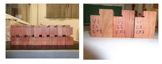
Figura 3. 25- Corpos de prova conforme a NBR 7190.
