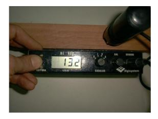
Figura 3. 10- Detalhe de medição da umidade em peça de madeira de *Eucalyptus saligna* após secagem.
