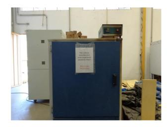
Figura 3. 16- Estufa usada para elevar a temperatura dos adesivos.
