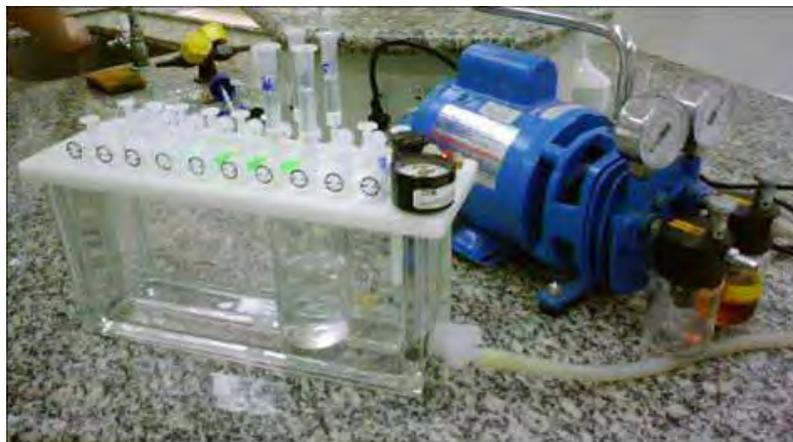
**Figura 7** – Extrator em fase sólida (SPE)
