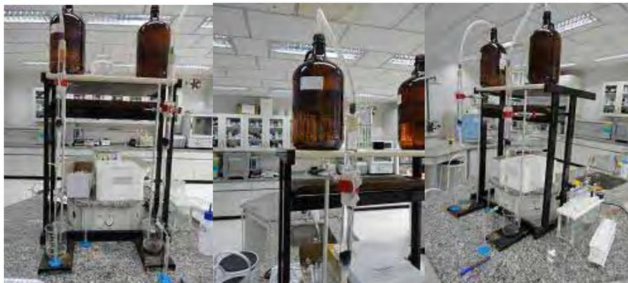
**Figura 6** – Experimentos de sorção e dessorção realizados em colunas recheadas com turfas TSA e TSI
