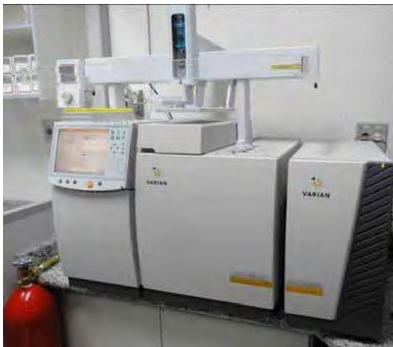
**Figura 8** – Cromatógrafo gasoso com Espectrômetro de massas acoplado (GC-MS)
