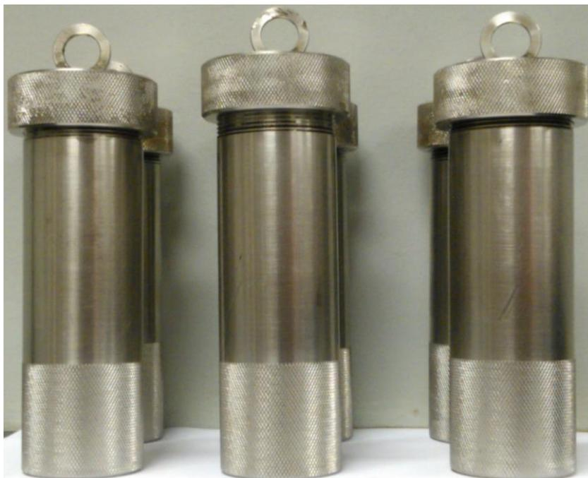
**Figura 10** – Minirreatores utilizado no processo de auto-hidrólise da serragem (MORAIS, 2015).
