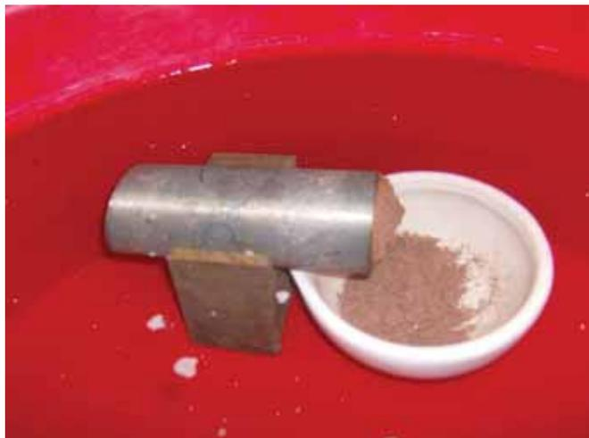
**Figura 41 – Corpo de prova em imersão no ensaio de perda de massa realizado dentro da metodologia Mini-MCV. Fonte: Autor.**
