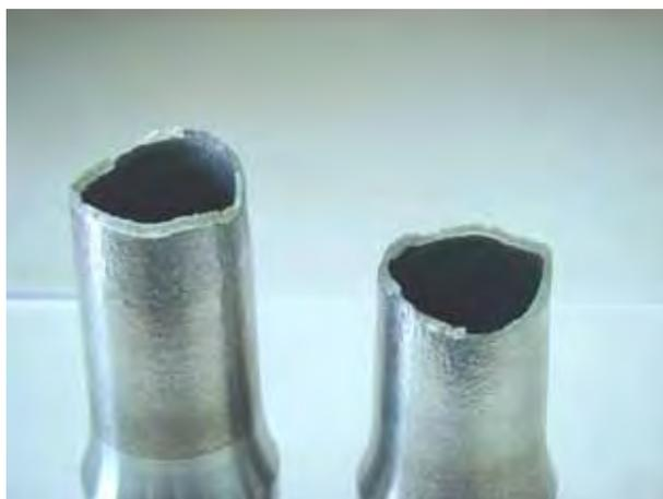
Figura 4.2 – Corpo-de-prova fraturado no ensaio de tração
