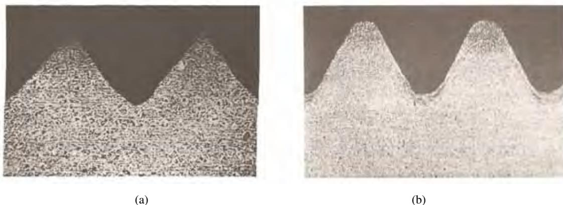
Figura 3.11 – Comparação entre rosca usinada e laminada; (a) filete de rosca de parafusos fabricados por tarraxa ou torno, as fibras do material não estão deformadas (ataque: nítrico. 40x); (b) filete de rosca produzida por laminação, nota-se a deformação das fibras do material e que a máxima deformação ocorre no fundo do filete (ataque: nítrico. 23x) (COLPAERT, 1974)
