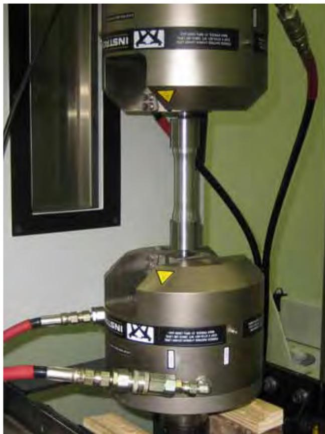
Figura 3.7 – Ensaio de fadiga utilizando a metodologia A
