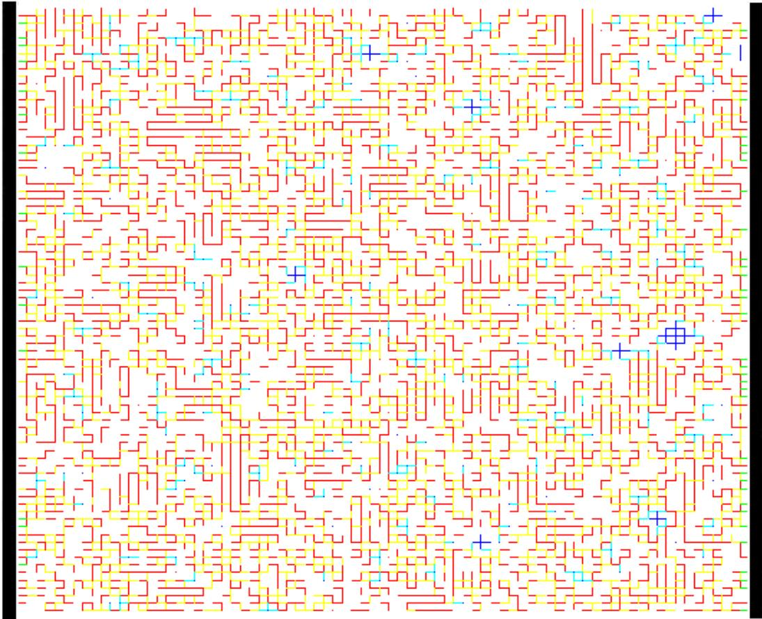
**Figura 42: Estrutura do compósito PU/NF com 1% de NF utilizando uma célula 80 x 80 sítios, formada por regiões duras, moles e grãos de negro de fumo. Barras verticais pretas: eletrodos; saltos intramoleculares: segmentos vermelhos; saltos intermoleculares: amarelos; saltos entre segmentos moleculares e o eletrodo; verdes; ligações de NF azuis; saltos entre os segmentos moleculares e grãos de negro de fumo; ciano.**
