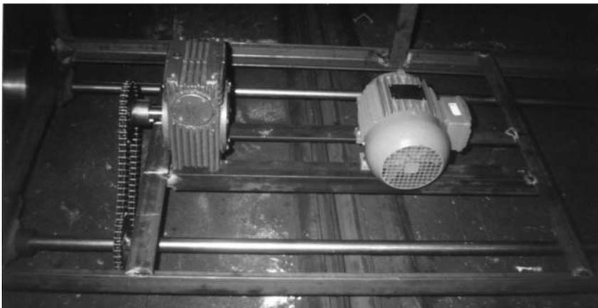
FIGURA 9. Vista do motor e do redutor
