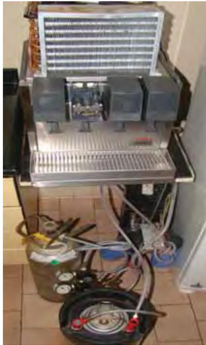
FIGURA 2 – Equipamento de carbonatação das bebidas lácteas sabor morango.
