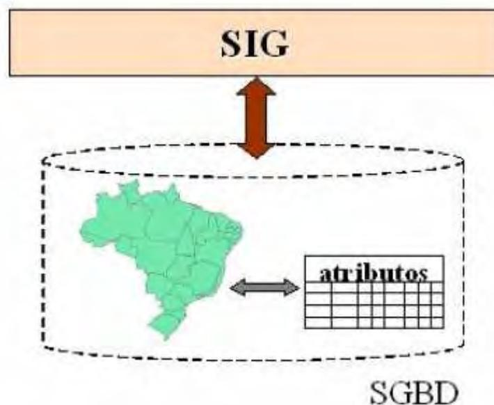
Figura 20: Modelo de arquitetura INTEGRADA
