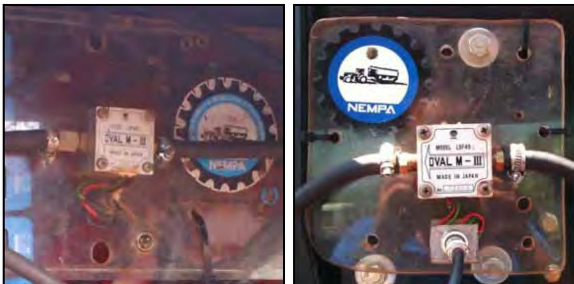
**Figura 13.** Fluxômetros instalados na entrada e no retorno do tanque da colhedora para determinação do consumo de combustível.
