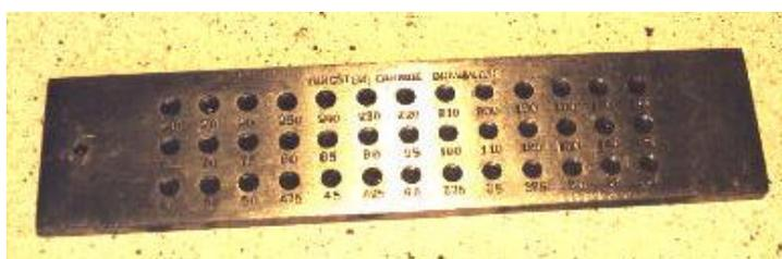
Figura 25 - Fieira com furos revestidos de metal duro.
