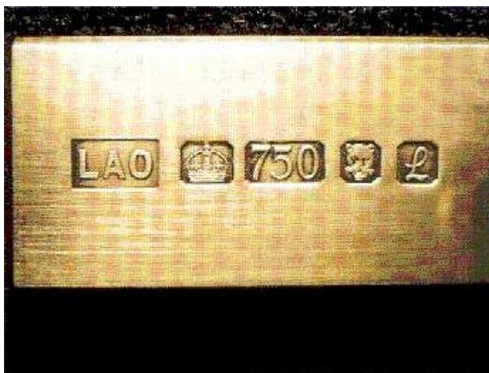
Figura 15 - Hallmark de 1985 para ouro padrão 750 (com a marca do escritório de ensaios – London Assay Office – LAO) (EVANS, 1991).
