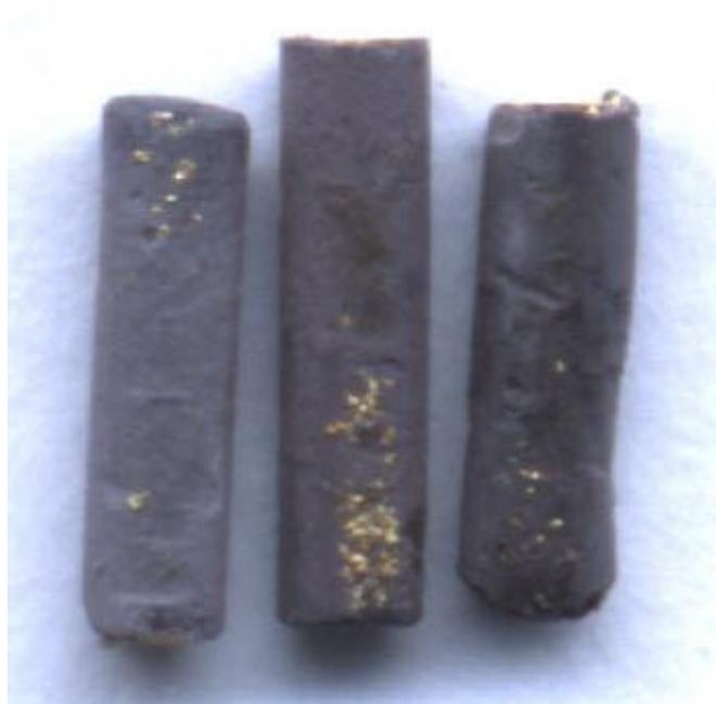
Figura 30 – Corpos-de-prova após ataque com reagentes: **2u**, **3u** e **5u**. Aumento: 10X.
