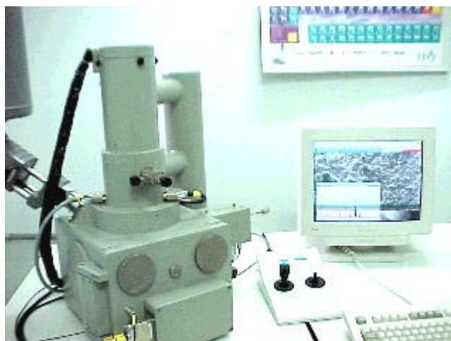
Figura 29 - Microscópios Eletrônicos de Varredura acoplado a analisador por Energia Dispersiva de Raios-X.(CTA/AMR, 2002)
