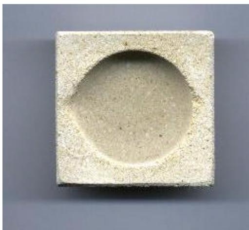
Figura 19 – Cadinho de cerâmica cinza, 80 x 80 x 30 mm.
