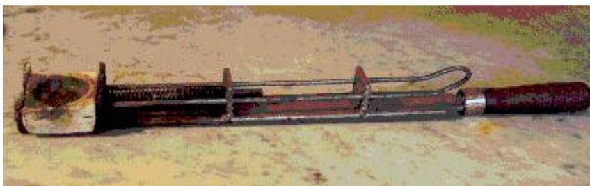
Figura 20 - Suporte para cadinho, mostrando o cadinho fixado em posição para uso.
