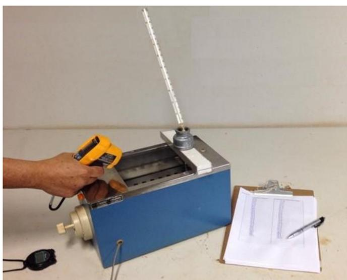
**FIGURA 5.** Calibração do termômetro de infravermelho. Laboratório de Instrumentação, Aquisição e Processamento (LIAP).
