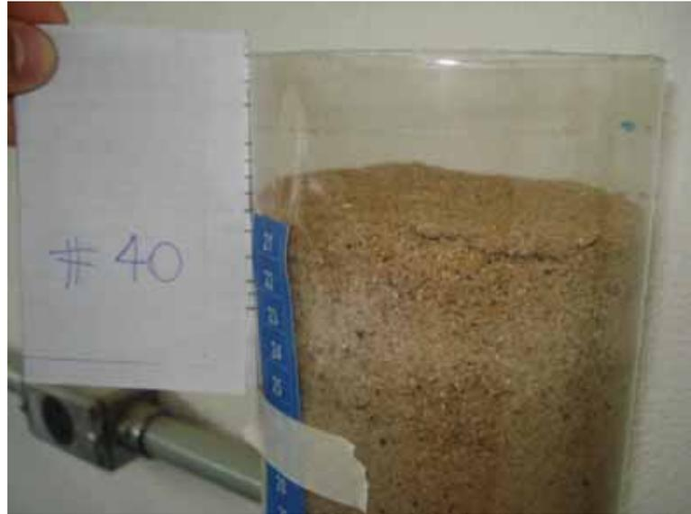
**Figura 40 - Corpo de prova com a camada superior seca (Fonte: Autor)**
