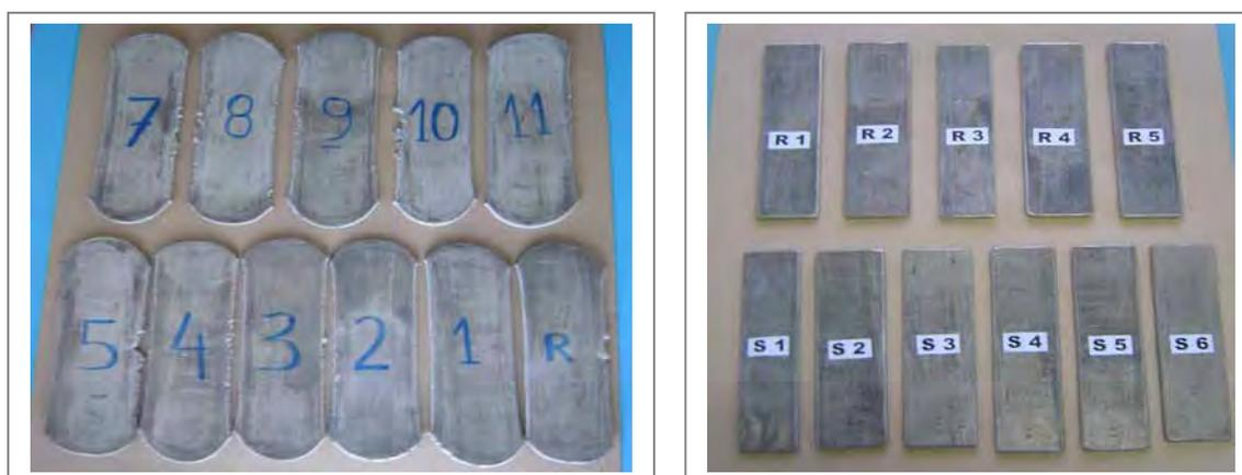
a) Placas antes da usinagem das bordas      b) Placas após a usinagem das bordas
