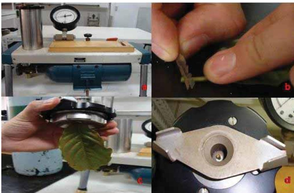
Figura 7. Bomba de pressão Scholander (a), corte na base do pecíolo da folha (b), inserção da folha na câmara da bomba com a base do pecíolo aparente (c e d).
